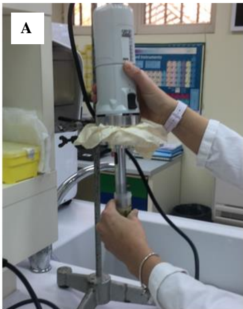
Slika 17. A) Korišteni homogenizator (Velp Scientifica OV5 homogenizator), B) Uzorci ostavljeni preko noći u vrtložnoj miješalici. (Izvor: vlastita fotografija ; slikano u laboratoriju Metris u Puli)
