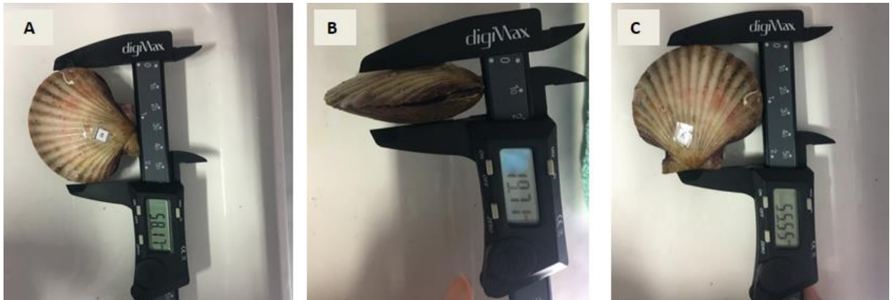
Slika 14. Prikaz mjerenja morfoloških obilježja ljuštore češljače A) dužina - SL, B) širina - ST, C) visina - SH pomoću digitalne pomične mjerke (Izvor: vlastita fotografija ; slikano u ustanovama Aquarium Pula)
