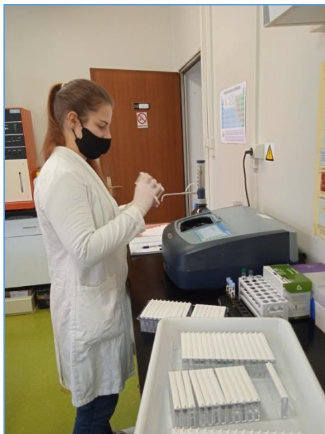
Slika 9. Mjerenje optičke gustoće algi na UV/VIS spektrofotometru DR6000 (Hach, SAD) nakon pripreme uzoraka te nakon 24, 48 i 72 sata inkubacije (fotografiju izradila: dr. sc. Želimira Cvetković).
