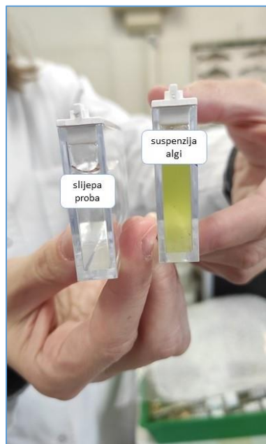
Slika 7. Kiveta s čistim medijem za uzgoj algi (slijepa proba) za kalibriranje spektrofotometra i kiveta suspenzije algi za prvo mjerenje apsorbancije i određivanje faktora razrjeđenja (fotografiju izradila: Amalia Brkić).
