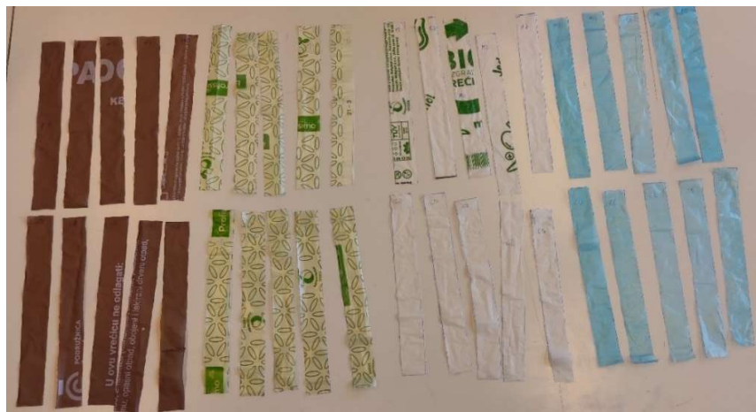
Slika 9. Priprema uzoraka za ispitivanje prekidne sile i prekidnog istezanja metodom trake (izvor: Martina Fileš, 2021.).
