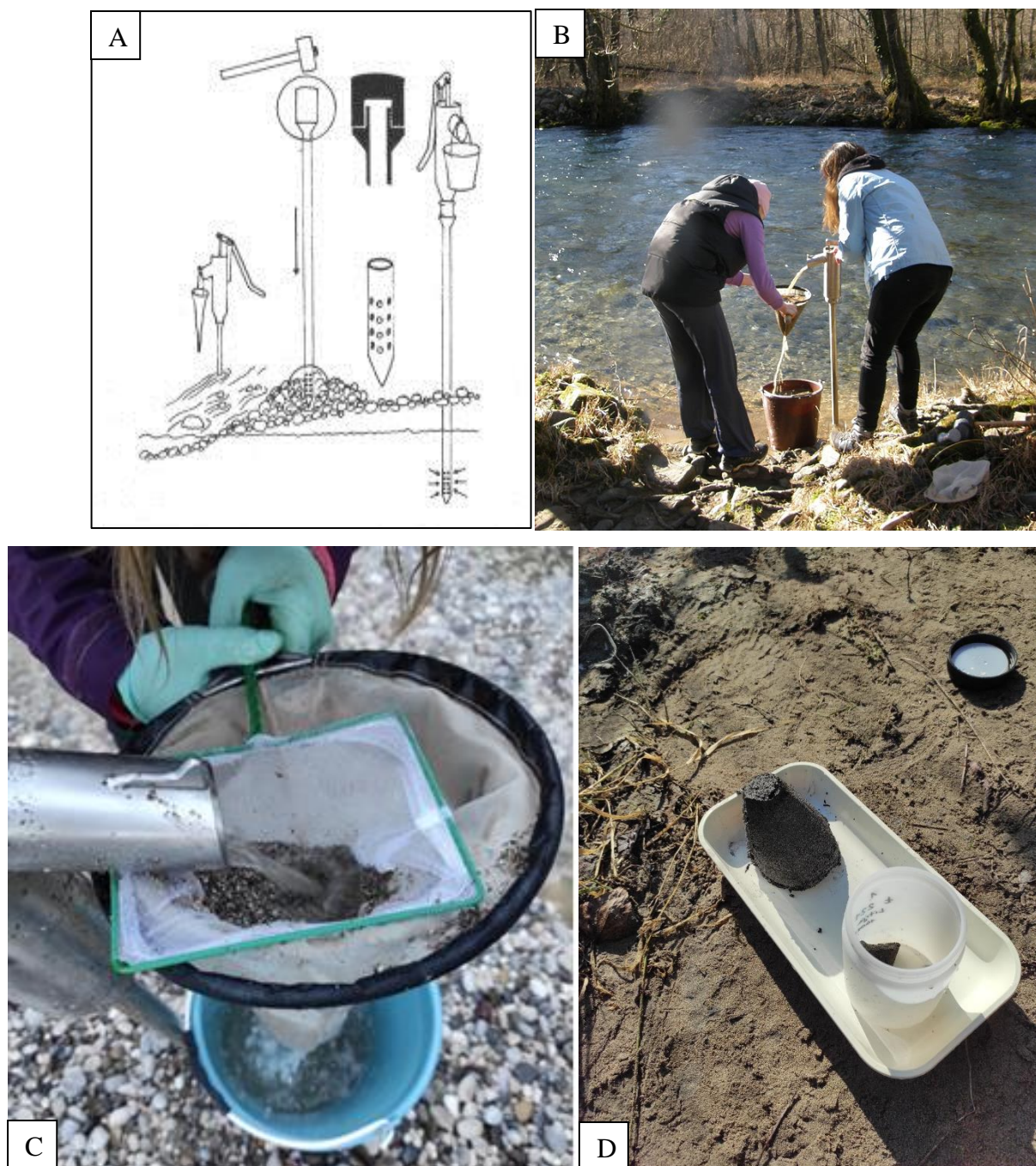
Slika 20. A) Prikaz Bou-Rouch pumpe i njenog korištenja u intersticijskoj zoni rijeke; B) prikaz metodologije terenskih istraživanja prikupljanja uzoraka iz hiporeičke zone izvorišnog toka Rječine primjenom Bou-Rouch pumpe; C) prikaz filtracije vode kroz mrežicu primjenom Bou-Rouch pumpe; D) prikaz uzorka prije konzerviranja.
