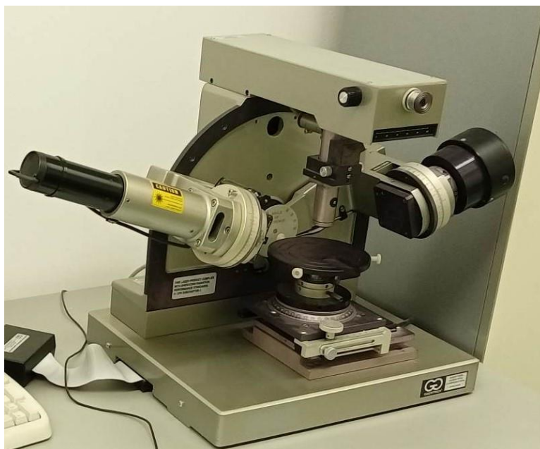
Slika 18. Elipsometar korišten u mjerenjima
