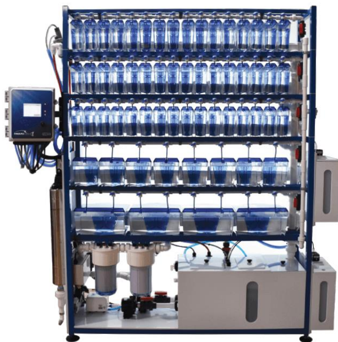
Slika 12. Sustav za uzgoj zebrice (Preuzeto sa: https://www.plexx.eu/wp-content/uploads/2020/06/labreedzebsystem.png ).
