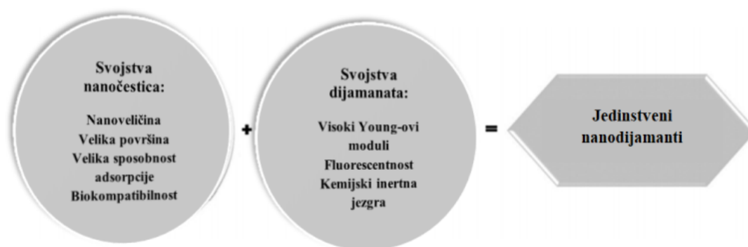
Slika 6. Jedinstvena svojstva nanodijamanata nastala kombinacijom svojstava nanočestica i dijamanata (preuzeto i prilagođeno prema 3)
