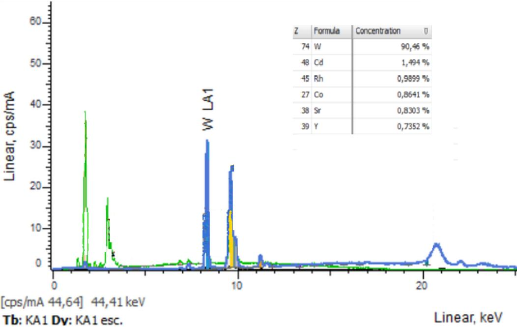
Slika 8.9: Kvalitativni i kvantitativni prikaz elemenata u monokristalu WC dobiven mjerjenjem XRF spektroskopijom.
