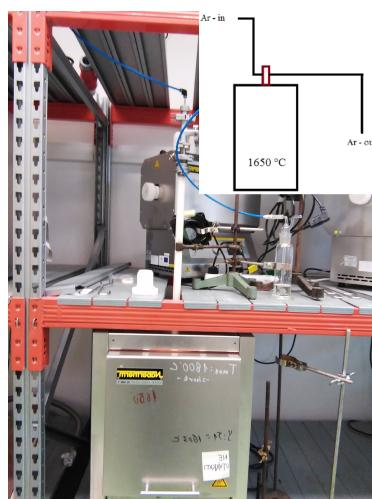
Slika 7.9: Modificirana pećnica za visokotemperaturnu sintezu WC
