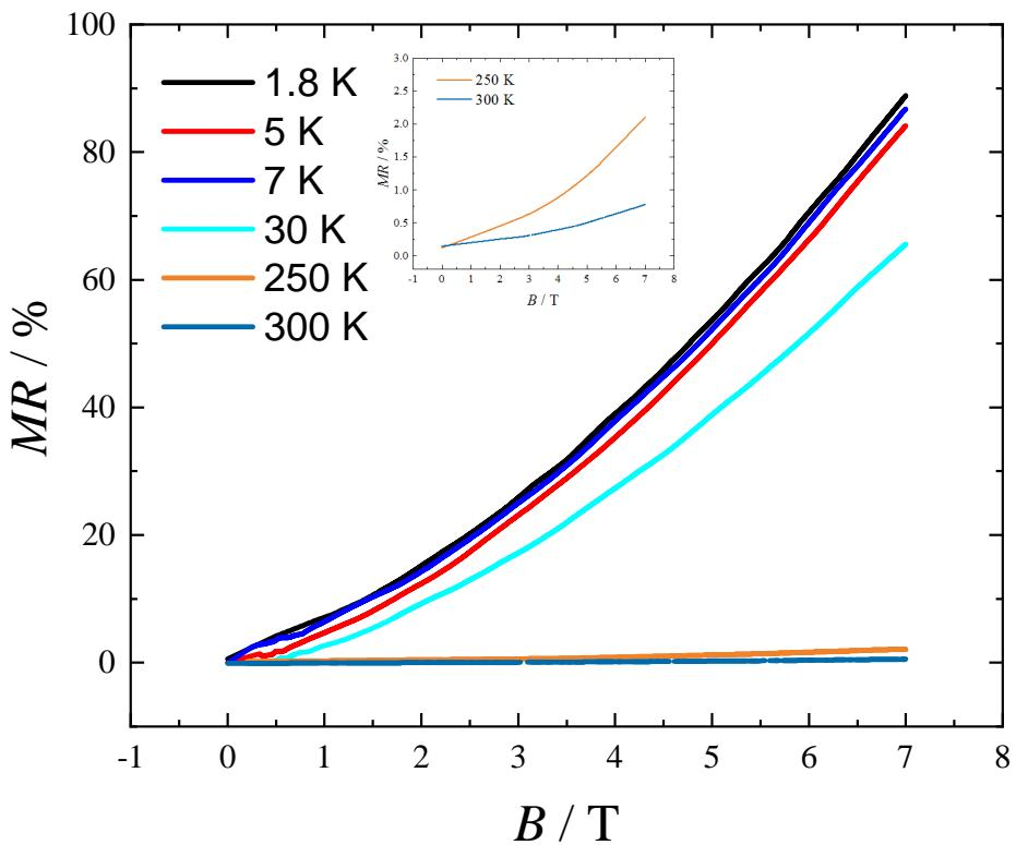
Slika 8.13: Magnetootpor uzorka WC u ovisnosti o  $B$  za set različitih temperatura. Vidimo da MR snažan porast za niske temperature te odsutstvo saturacije.
