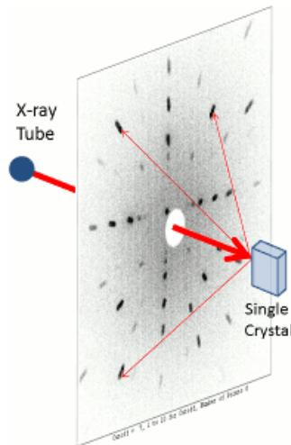
Slika 6.2: Shematski prikaz ogibanja X - zraka na kristalnoj rešetci i nastanak lauegrama - preuzet s: <http://multiwire.com/index.shtml>
