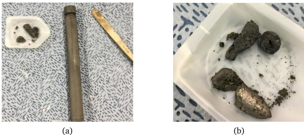
Slika 8.3: Prikaz uzorka S5 dobivenog CVT sintezom izvađenog iz grafitnog lončića
