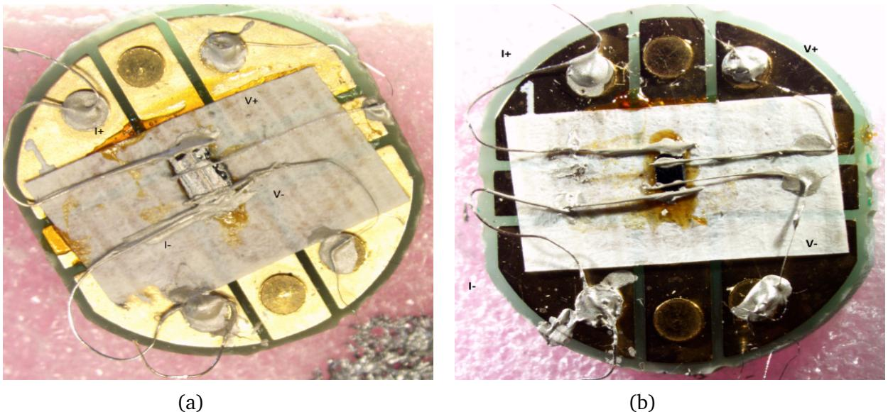
Slika 6.4: Uvećani prikaz kontakata pod mikroskopom zaliđenih srebrenom pastom, metodom četiri kontakta mjeri se otpornost a) WC i b) BaNiS<sub>2</sub>.
