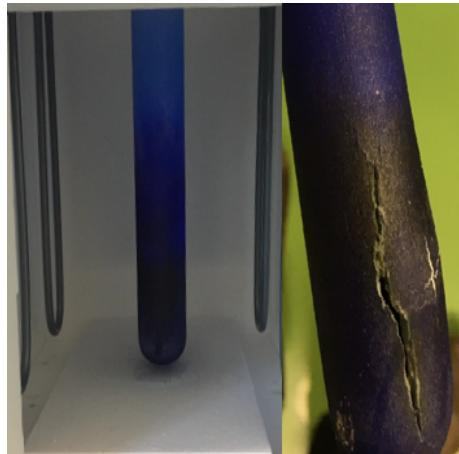
Slika 7.10: Kobaltovo modrilo nastalo uslijed sinteze WC - a u vakuumu zbog pro-
