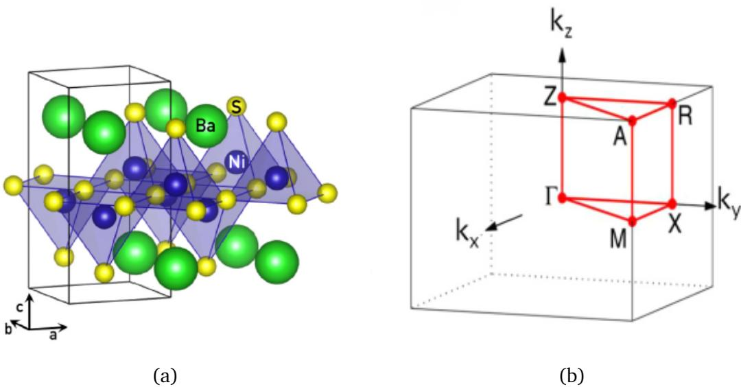
Slika 4.3: a) Tetragonalna struktura  $\text{BaNiS}_2$  sustava s označenom jediničnom ćelijom, preuzeto iz [29], b) pripadajuća BZ s crveno označenim točkama i linijama visokih simetrija - preuzeto iz [30].
