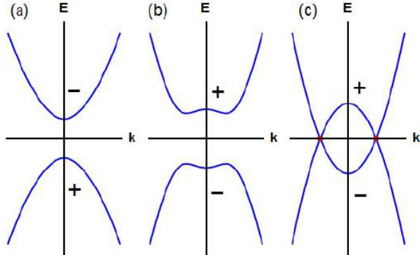
Slika 3.9: Inverzija vrpcu invertira paritet  $\pm \mathbf{k} = 0$  svojstvenih stanja u a) neinvertiranoj vrpcu, b) dvostruko degeneriranoj invertiranoj vrpcu koja se presijeca u  $\mathbf{k} \neq 0$  i stvara procijep u sustavu. c) Mješanje vrpcu zabranjeno je duž linije visoke simetrije zbog rotacijskih simetrija vrpcu, dvije točke  $\pm \mathbf{k}_D$  preostaju četverostruko degenerirane duž linije visoke simetrije - preuzeto iz [3].
