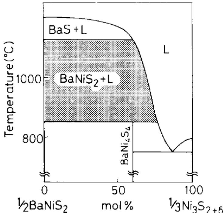
Slika 5.7: Shematski prikaz faznog dijagrama  $\text{BaNiS}_2$  - preuzeto iz [22].
