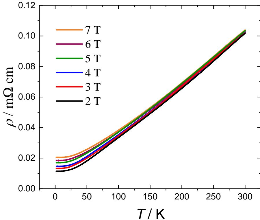
Slika 8.12: Otpornost uzorka WC u ovisnosti o temperaturi za polja do 7 T u temperaturnom rasponu od 1.8 K do 300 K.
