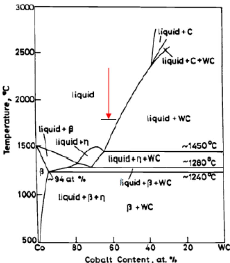
Slika 5.1: Shematski prikaz faznog dijagrama WC - Co s crveno označenom strelicom koja pokazuje polazišnu točku u sintezi monokristala - preuzeto iz [24].
