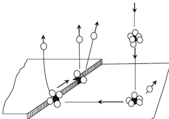
Slika 5.6: Prikaz rasta kristala mehanizmom sloj po sloj, u kojem otapalo prelazi u otopinu, otopljeni tvar ostaje na kristalu - preuzeto iz [20].
