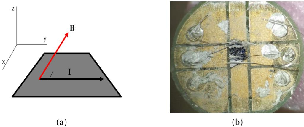
Slika 8.10: a) Eksperimentalni postav za mjerjenje WC uzorka u kriostatu, struja i vanjsko magnetsko polje su okomiti i leže u  $x - y$  ravnini, b) izmjereni uzorak.
