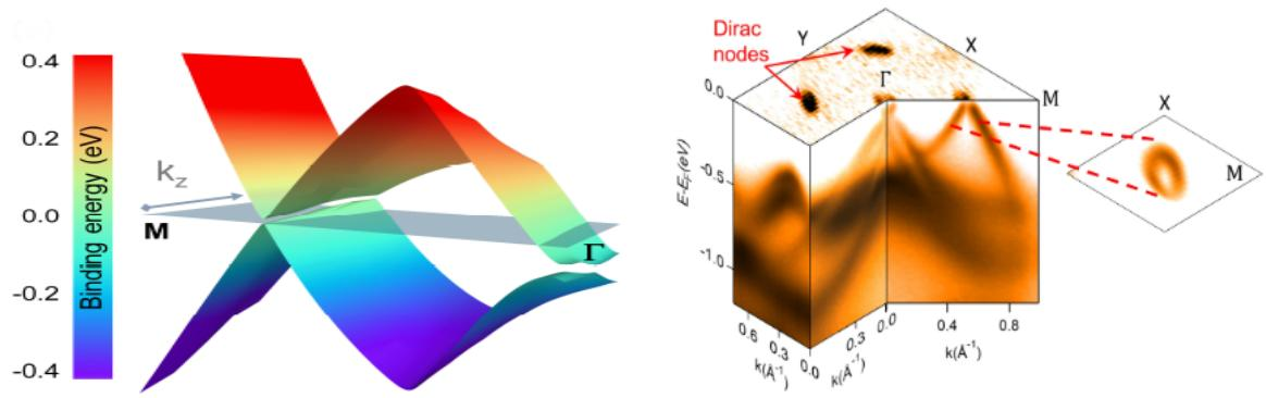
Slika 3.11: a) Prikaz dvije Diracove nodalne linije u dodiru u sustavu  $\text{BaNiS}_2$ , preuzeto iz [15], b) ARPES spektrogram  $\text{BaNiS}_2$ . Na gornjoj plohi je prikazana Fermijeva površina, a na stranicama disperzija vrpci u smjerovima visoke simetrije - preuzeto iz [3].
