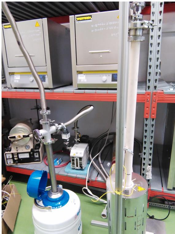
Slika 7.6: Tubularna peć u kojoj se peku lončići za sintezu od grafita. Tijekom sinteze cijev se vakuumira i prolazi kroz hladnu klopku.
