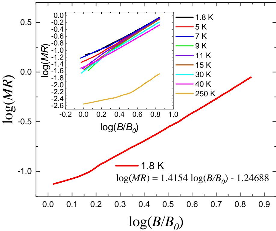
Slika 8.14: Određivanje eksponenta ovisnosti MR o magnetskom polju,  $MR = aB^n$ . Vidimo da je eksponent manji od 2, vrijedost koju daje semi-klasičan model transporta.
