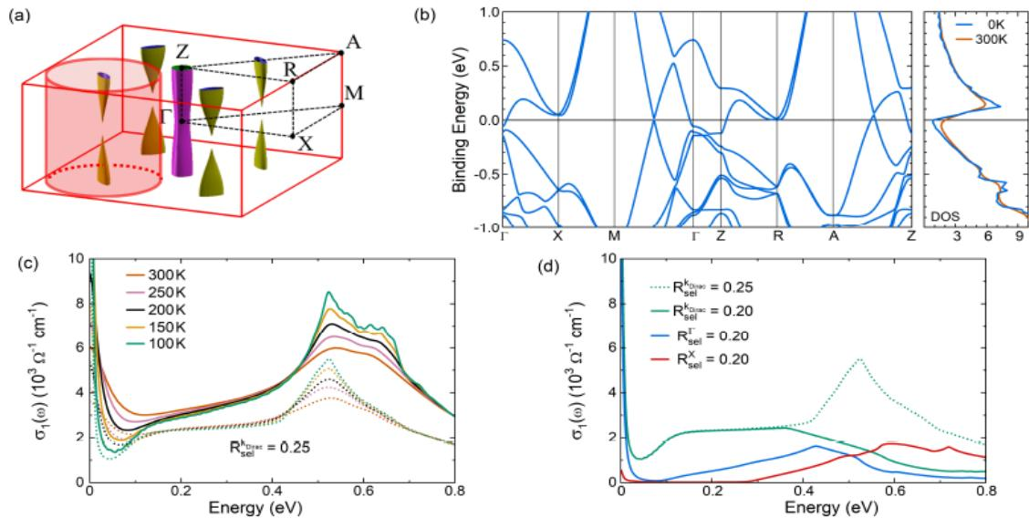
Slika 4.4: a), b) Prikaz BZ  $\text{BaNiS}_2$  i pripadna DFT (eng. *density functional theory*) disperzija vrpcu, c) Niskoenergetska optička vodljivost pune BZ, d) optička vodljivost dekomponirane BZ za vidljivost pojedinih doprinosa - preuzeto iz [15]
