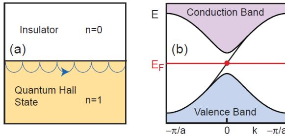
Slika 3.3: a) Prikaz izolatorskog i kvantnog Hallovog stanja te pripadnih Chernovih brojeva, elektroni pri površini izvode ciklotronske orbite. b) Pripadna disperzija energija vodljive i valentne vrpcu između kojih je procijep i površinsko stanje koje ih povezuje. Zbog slomljene simetrije na vremensku inverziju disperzija izgleda kao  $1/2$  Diracove disperzije, prisutna je samo jedna grana - preuzeto iz [10]
