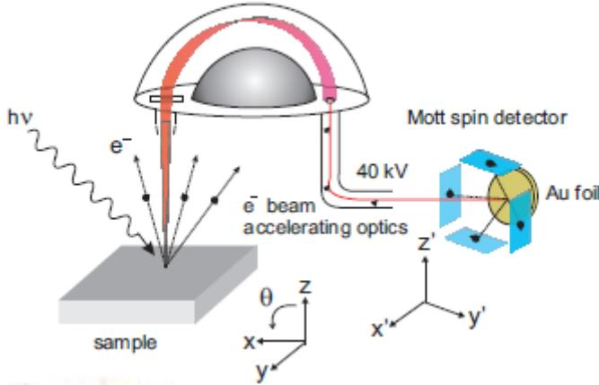
Slika 3.5: Shematski prikaz Spin - ARPES spektroskopije, ARPES nam omogućuje direktno dobivanje informacija o vrpčastoj strukturi materijala i o spinskoj polarizaciji vrpcu - preuzeto iz [10].
