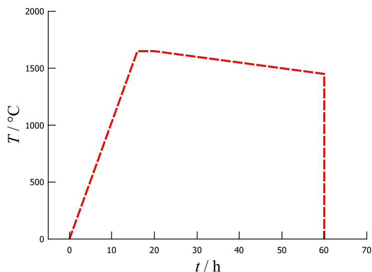
Slika 7.8: Program peći za sintezu monokristala WC
