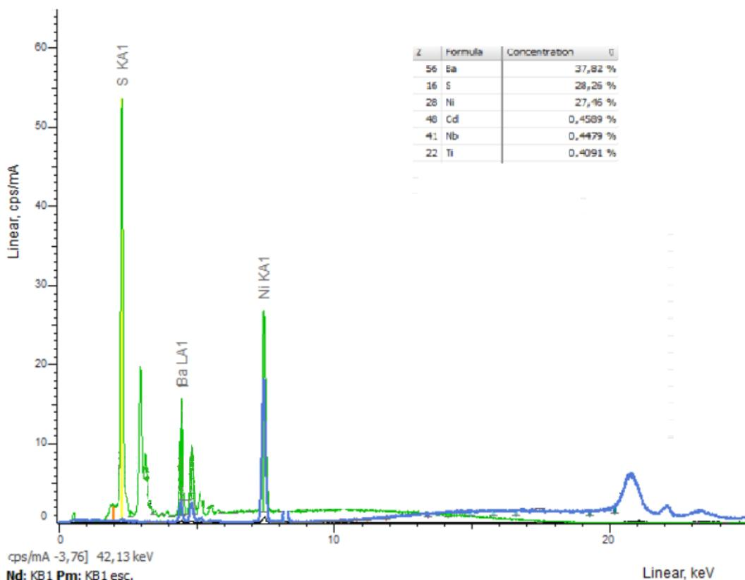
Slika 8.4: Kvalitativni i kvantitativni prikaz elemenata u monokristalu  $\text{BaNiS}_2$  uzorku dobiven mjerjenjem XRF spektroskopijom
