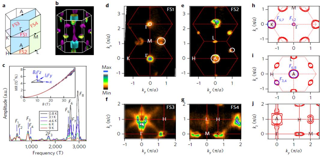
Slika 4.2: Prikaz ARPES mjerjenja na WC - u, a) prikaz BZ s 4 ravnine, b) izračunata Fermijeva povšina dubinskih stanja u BZ, c) FFT spektar kvantnih oscilacija koji pokazuje 8 različitih harmonika, i umetnuto: magnetizacija u ovisnosti o  $B$ , d) - g) fotoemisijski intenzitet na Fermijevoj energiji, pokazuju Fermijevu plohu duž 4 ravnine visoke simetrije, h) - j) simulirana Fermijeva površina - preuzeto iz [26].
