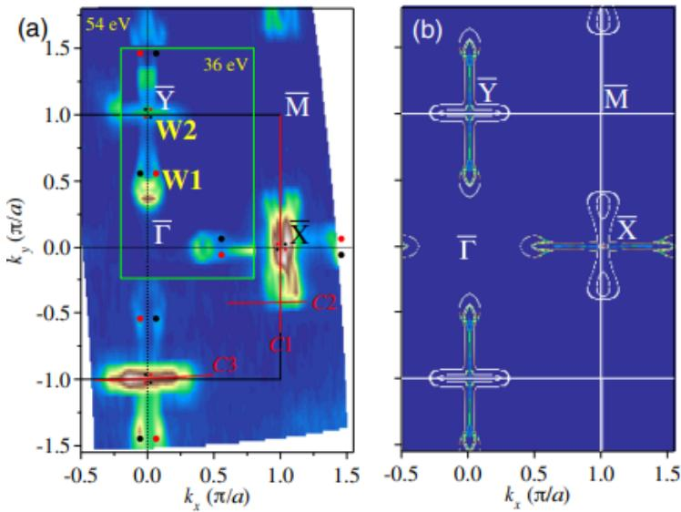
Slika 3.8: Fermijeva površinska stanja na TaAs (001), a) prikaz intenziteta na  $E_f$ , W1 i W2 označuju prikaz Weylovih točaka projiciranih na površinu, crvene i crne točke označuju stanja suprotne kiralnosti, b) računalna simulacija Fermijevih površinskih stanja na (001) TaAs u suglasnosti s eksperimentalnim pronašlaskom - preuzeto iz [19].
