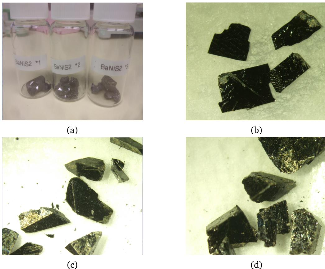
Slika 8.1: a) Prikaz uzoraka S1, S2 i S3 te pripadnih kristala, iz svakog uzorka uzeti su najbolji primjerci te su mehanički odvojeni dobri kandidati b) površinski sloj uzorka S1 koji odgovara monokristalnoj fazi BaNiS<sub>2</sub>, c) Uzorak S2 s vrlo tankom crnom fazom na površini, d) S3 uzorak lošije kvalitete.
