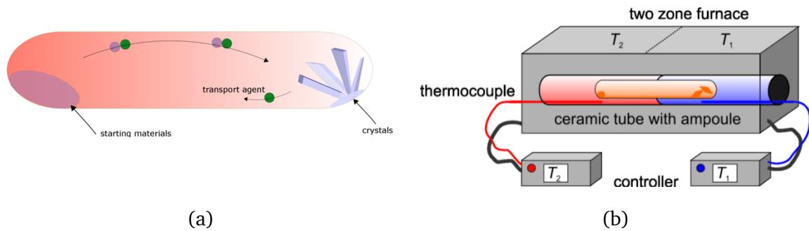
Slika 5.3: Slika a) prikaz transporta jodom unutar kvarcne ampule, b) dvozonska peć s gradijentom u kojoj je gradijent temperature - preuzeto iz [25].
