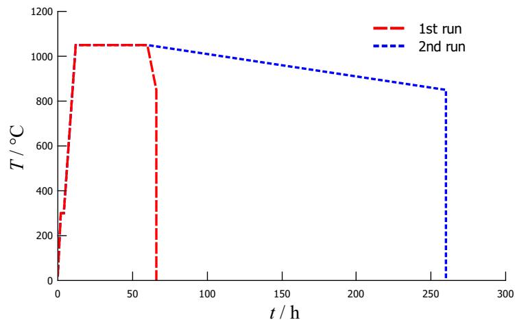
Slika 7.5: Program mufolne peći za sintezu monokristala BaNiS<sub>2</sub>.
