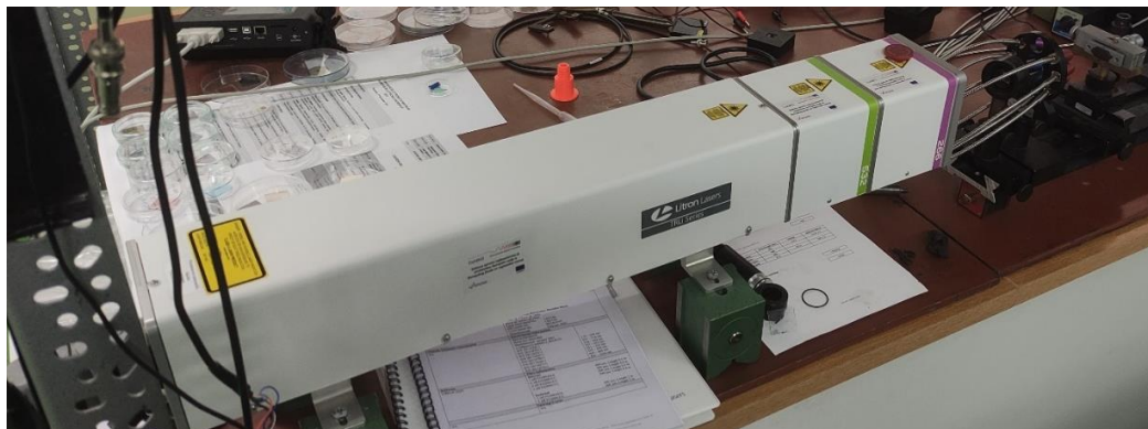
Slika 15 Laserska glava na koju su dodani harmonički moduli. U laserskoj glavi nalazi se laser Litron TRLi G 450-10, LPU 1000.
