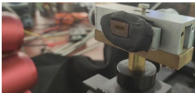
Slika 19 Prikaz stalka na kojeg se pomoću plastelina učvrstio meteorit
