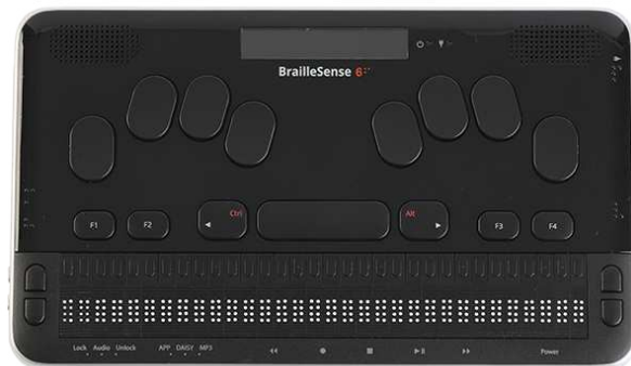
Slika 7: Braille SENSE Plus - elektronička bilježnica za slijepe
