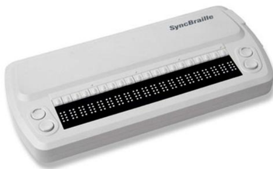
Slika 6: SyncBraille - najmanji Brailleev redak
