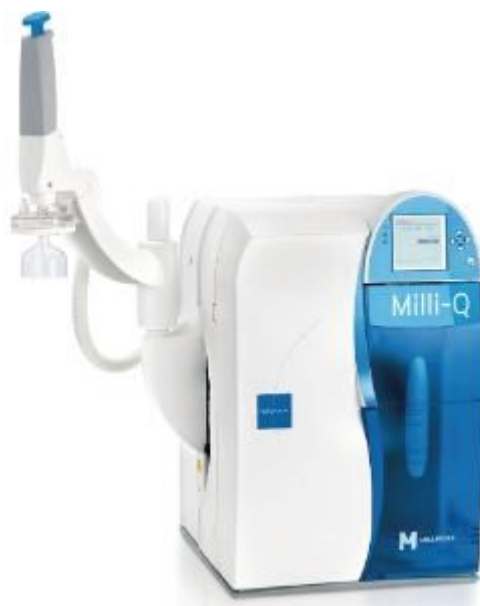
Slika 11. Uređaj za visokopročišćenu vodu
