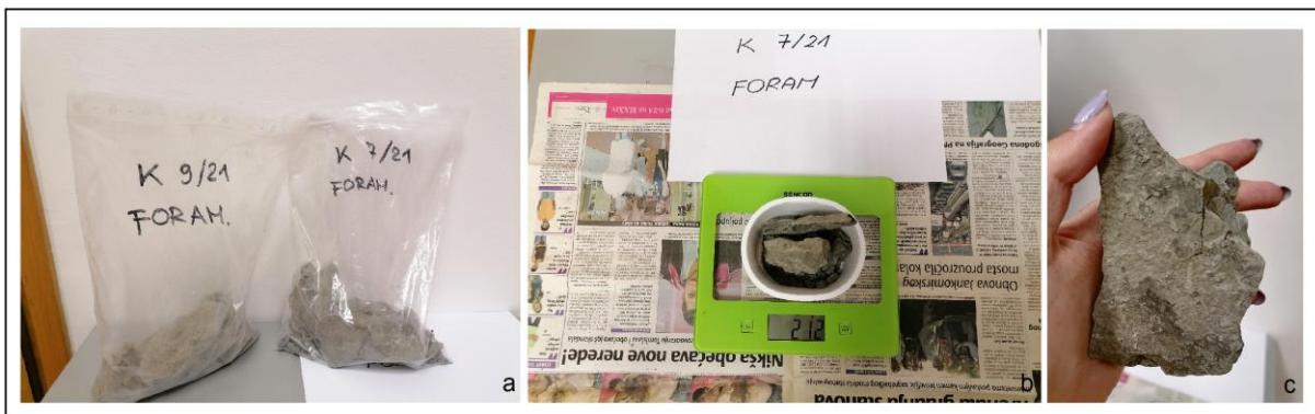
Slika 8. a) Uzorci litificiranih lapora u plastičnim vrećicama; b) Vaganje uzorka K-7 za potrebe usitnjavanja; c) Uzorak litificiranog lapora uzet za laboratorijska istraživanja
