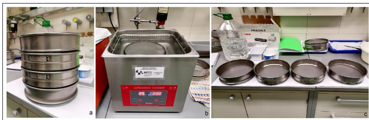
Slika 10: a) Sita poredana od najmanjeg promjera ka najvećem (63, 125, 250, 500 mikrometara); b) Ulrazvučna/ultrasonična kadica; c) Sita pojedinačno.
