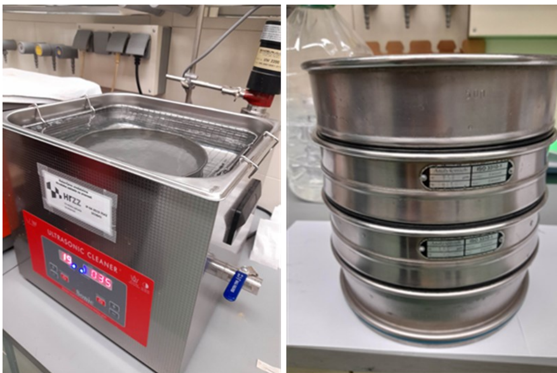
Slika 11 a) Ultrasonična kadica b) Sita sa četiri različita promjera
