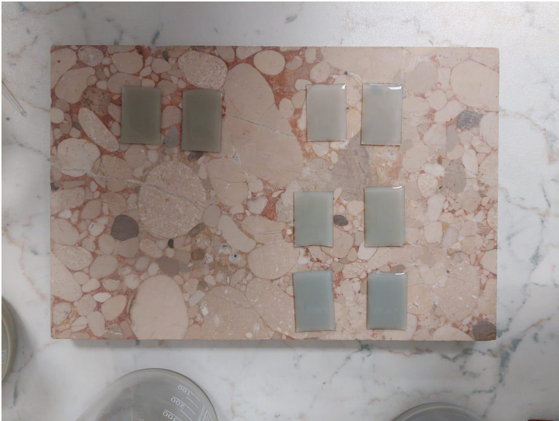
Slika 13. Priprema orijentiranih preparata nakapavanjem
