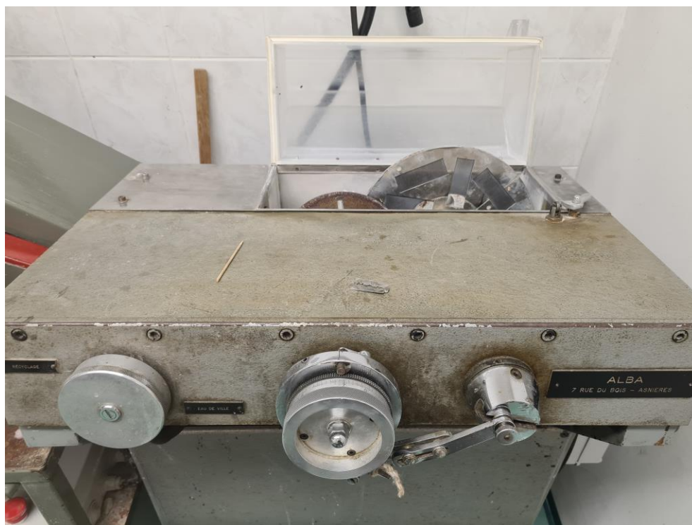
Slika 7. Stroj za istanjivanje uzoraka „Alba“
