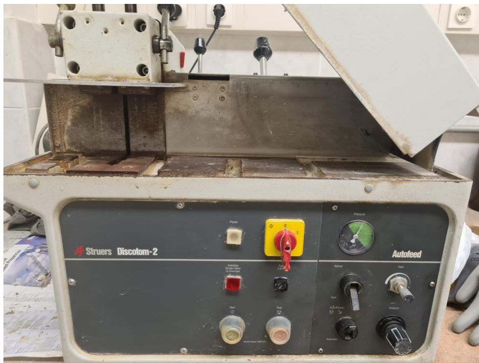
Slika 6. Stroj za rezanje stijena „Struers“
