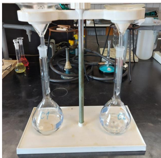
Slika 21: Filtracija uzoraka C1 i C2
