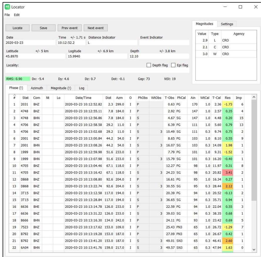
Slika 32. Primjer dobro lociranog potresa lokalne magnitudo 2.9 potpunom automatizacijom softvera SEISAN
