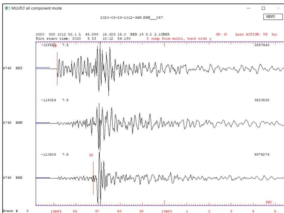
Slika 33. Detalj istog potresa u obliku trokomponentnog zapisa sa seismološke postaje Zagreb. Na zapisu se dobro vide detektirani dolasci P i S faza
