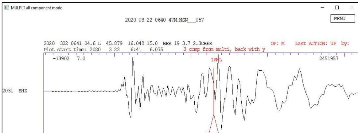
Slika 21. Primjer automatskog određivanje maksimalne amplitudine na vertikalnoj komponenti trokomponentnog zapisa sa seizmološke postaje Puntijarka
