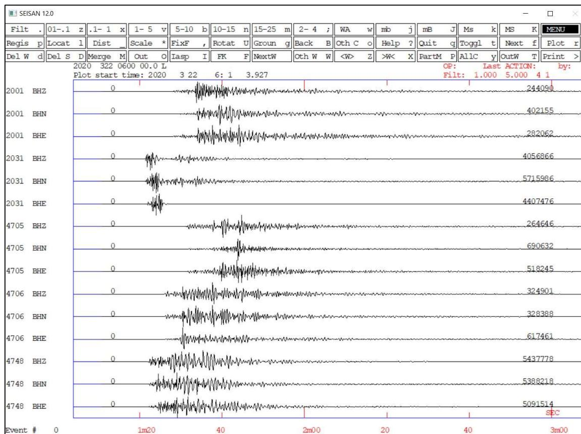
Slika 14. Primjer izdvojenih zapisa kontinuirane arhive s 4 seismološke postaje u vremenskom periodu od 60 minuta
