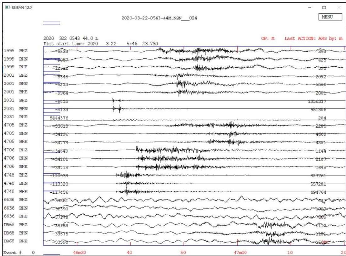
Slika 29. Primjer potresa jasno zabilježenog na većem broju seismoloških postaja unutar selektirane mreže za detekciju. Ovakav potres uspješno je detektiran i registriran s oba testirana algoritma
