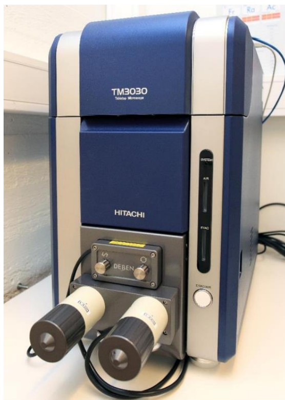
Slika 14. Skenirajući elektronski mikroskop HITACHI TM3030 Tabletop Microscope, korišten tijekom izrade rada
