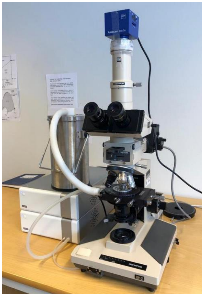
Slika 16. Mikroskop s komoricom (Linkam THMS 600) korišten tijekom izrade rada za mikrotermometrijska mjerenja
