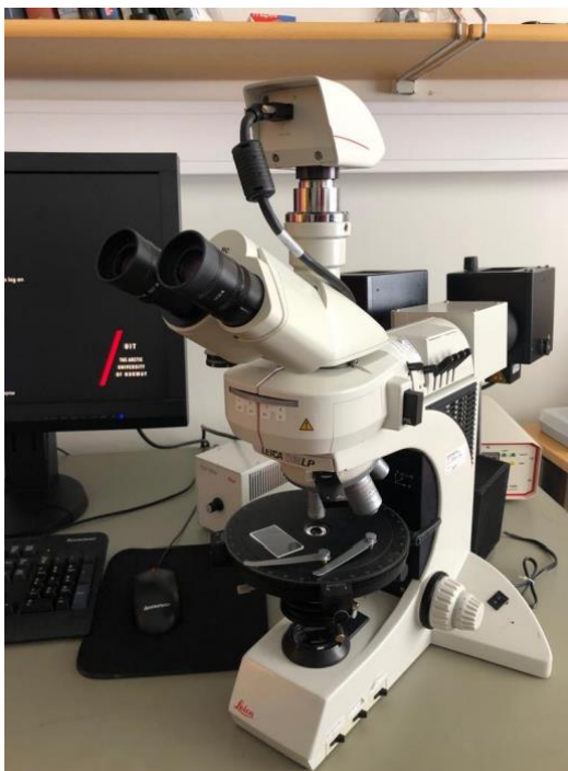
Slika 13. Polarizacijski mikroskop Leica DMLP s pričvršćenom kamerom Leica DFC 450 korišteni u svrhu optičkih istraživanja u reflektiranoj svjetlosti te fotografiranju uzoraka i fluidnih inkluzija
