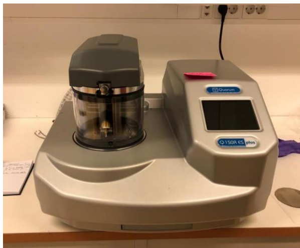
Slika 15. Naparivač QUORUM Q150R Plus korišten za pripremu uzoraka za SEM analizu
