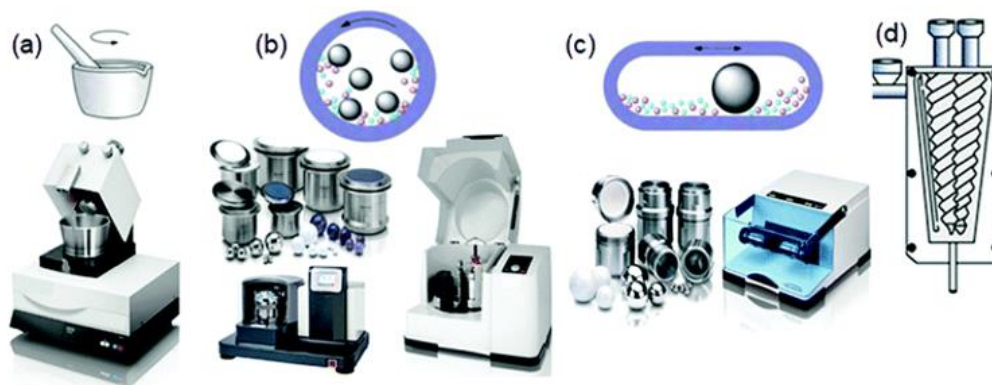
Slika 10. Pribor i uređaji korišteni za mehanokemijsku sintezu: a) tarionik i tučak, b) planetarni mlin, c) kuglični mlin, d) preša u obliku vijka.
