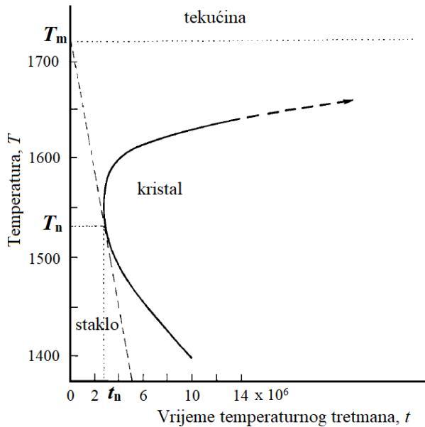
Slika 3. Shematski prikaz  $T-T-T$  dijagrama silicijeva dioksida.<sup>1</sup>
