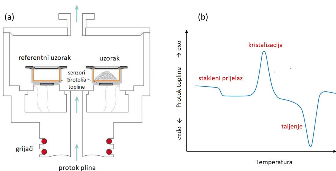
Slika 24. Shematski prikaz (a) sustava za DSC mjerjenja i (b) tipične DSC krivulje stakla.
