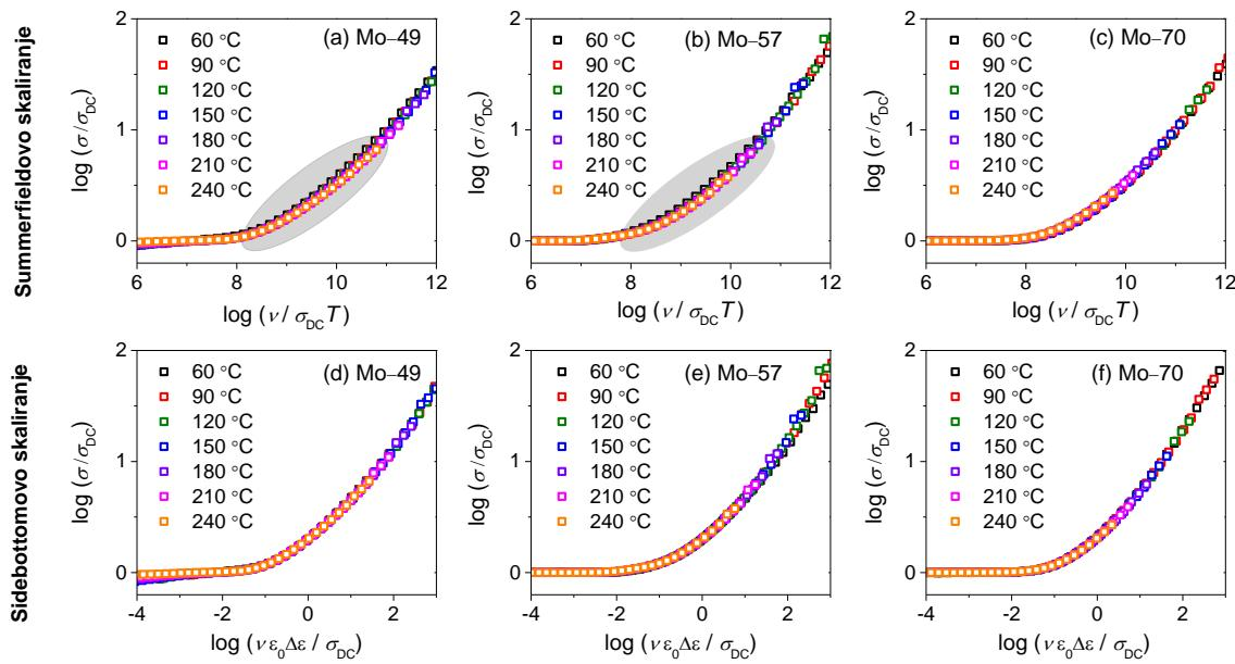
Slika 40. Spektri provodnosti Mo-49, Mo-57 i Mo-70 stakala iz serije  $x\text{MoO}_3-(100-x)\text{P}_2\text{O}_5$ ,  $x = 49-80\%$ , skalirani primjenom (a-c) Summerfieldovog i (d-f) Sidebottomovog postupka.
