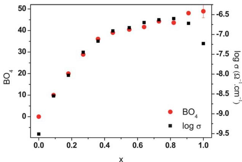
Slika 14. Usporedba ovisnosti relativnog udjela  $BO_4$  jedinica i električne provodnosti pri sobnoj temperaturi za seriju stakla sastava  $45Li_2O - 55[xB_2O_3 - (1-x)P_2O_5]$ ,  $x = 0-1\%$ .<sup>61</sup>
