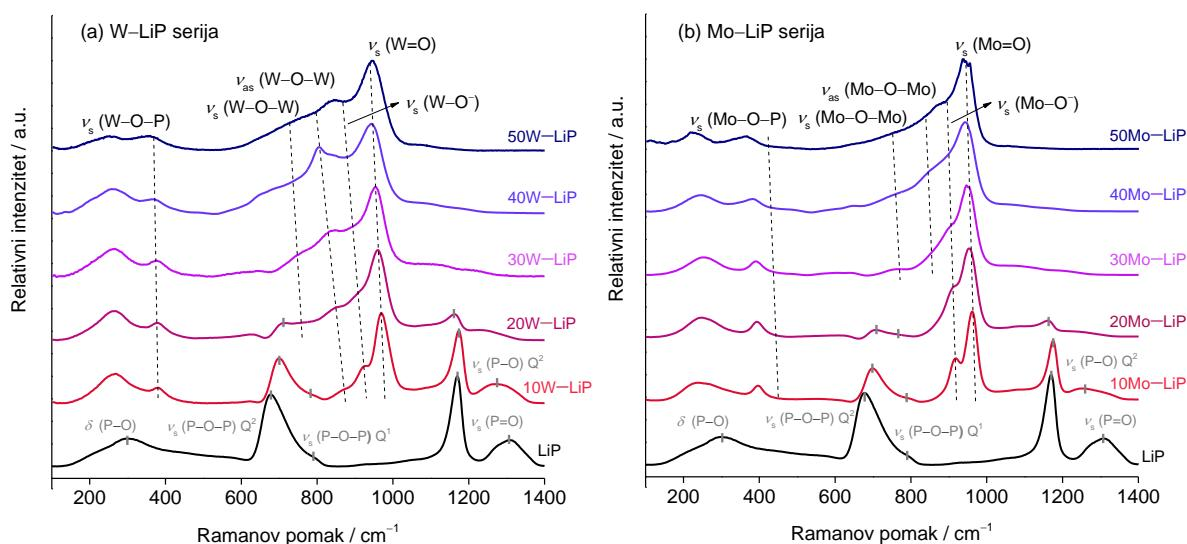
Slika 45. Ramanovi spektri serija stakala (a)  $x\text{WO}_3\text{--}40\text{Li}_2\text{O}\text{--}(60\text{--}x)\text{P}_2\text{O}_5$  i (b)  $x\text{MoO}_3\text{--}40\text{Li}_2\text{O}\text{--}(60\text{--}x)\text{P}_2\text{O}_5$ ,  $x = 0\text{--}50\%$ .
