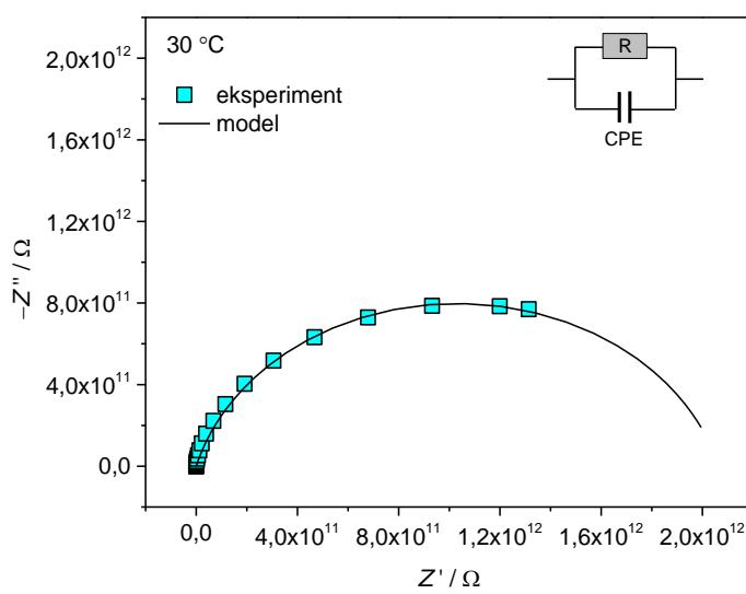
Slika D1. Kompleksna impedancijska ravnina za Mo–49 staklo na 30 °C. Točkama je označen eksperimentalni spektar, a linijom *fit* dobiven modeliranjem pripadajućim ekvivalentnim krugom. Iz modeliranja su određeni parametri  $R = 2,06 \times 10^{12} \Omega$ ,  $A = 3,41 \times 10^{-12}$  i  $\alpha = 0,84$ .
