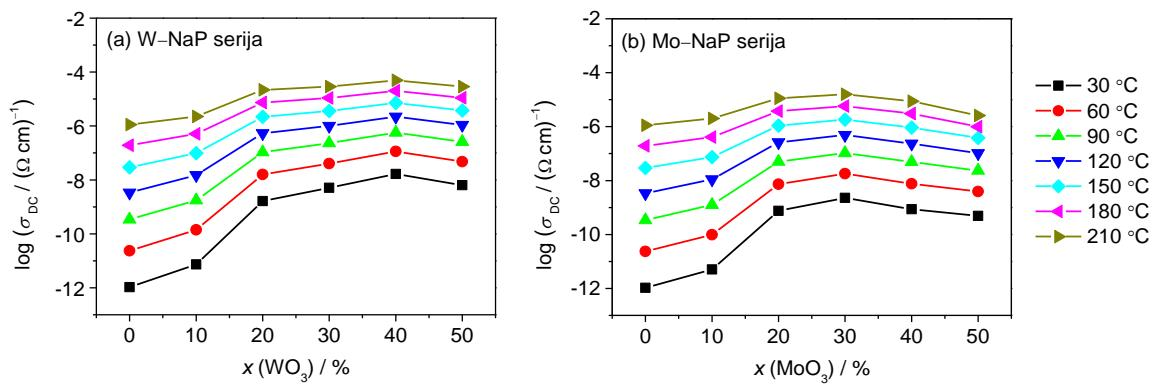
Slika D6. Ovisnost DC provodnosti na razlicitim temperaturama o udjelu  $WO_3$  odnosno  $MoO_3$  za stakla iz serija (a)  $xWO_3-40Na_2O-(60-x)P_2O_5$  i (b)  $xMoO_3-40Na_2O-(60-x)P_2O_5$ ,  $x = 0-50 \%$ .
