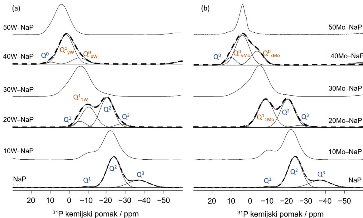
Slika 61.  $^{31}\text{P}$  MAS-NMR spektri serija stakala (a)  $x\text{WO}_3-40\text{Na}_2\text{O}-(60-x)\text{P}_2\text{O}_5$  i (b)  $x\text{MoO}_3-40\text{Na}_2\text{O}-(60-x)\text{P}_2\text{O}_5$ ,  $x=0-50\%$ .
