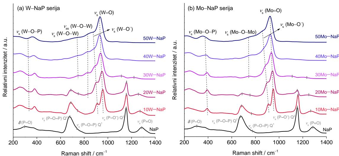
Slika 60. Ramanovi spektri serija stakala (a)  $x\text{WO}_3\text{--}40\text{Na}_2\text{O}\text{--}(60\text{--}x)\text{P}_2\text{O}_5$  i (b)  $x\text{MoO}_3\text{--}40\text{Na}_2\text{O}\text{--}(60\text{--}x)\text{P}_2\text{O}_5$ ,  $x = 0\text{--}50\%$ .
