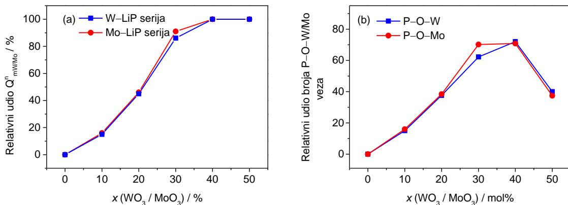
Slika 48. Ovisnost (a) ukupnog relativnog udjela „miješanih“  $Q^n_{\text{mW/Mo}}$  jedinica i (b) relativnog udjela broja P–O–W te P–O–Mo veza za serije stakala  $x\text{WO}_3\text{--}40\text{Li}_2\text{O}\text{--}(60\text{--}x)\text{P}_2\text{O}_5$  i  $x\text{MoO}_3\text{--}40\text{Li}_2\text{O}\text{--}(60\text{--}x)\text{P}_2\text{O}_5$ ,  $x = 0\text{--}50\%$ .
