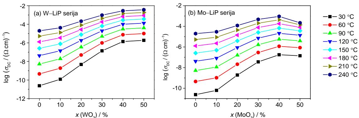
Slika D5. Ovisnost DC provodnosti na različitim temperaturama o udjelu  $\text{WO}_3$  odnosno  $\text{MoO}_3$  za stakla iz serija (a)  $x\text{WO}_3-40\text{Li}_2\text{O}-(60-x)\text{P}_2\text{O}_5$  i (b)  $x\text{MoO}_3-\text{Li}_2\text{O}-(60-x)\text{P}_2\text{O}_5$ ,  $x=0-50\%$ .
