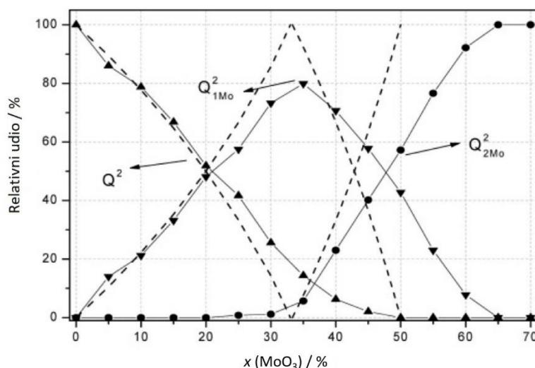
Slika 18. Relativni udjeli strukturnih jedinica dobiveni dekonvolucijom  ${}^{31}\text{P}$  MAS-NMR spektara serije stakala  $(100-x)\text{NaPO}_3-x\text{MoO}_3$  ( $0 \leq x \leq 70\%$ ). Isprekidane linije označavaju relativne udjele jedinica temeljene na teorijskom binarnom modelu.<sup>29</sup>
