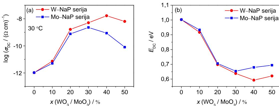
Slika 67. Ovisnost (a) DC provodnosti na  $30^\circ\text{C}$  i (b) energije aktivacije za DC provodnost o množinskom udjelu  $\text{WO}_3$  i  $\text{MoO}_3$  u serijama stakala  $x\text{WO}_3\text{--}40\text{Na}_2\text{O}\text{--}(60-x)\text{P}_2\text{O}_5$  i  $x\text{MoO}_3\text{--}40\text{Na}_2\text{O}\text{--}(60-x)\text{P}_2\text{O}_5$ ,  $x = 0\text{--}50\%$ .
