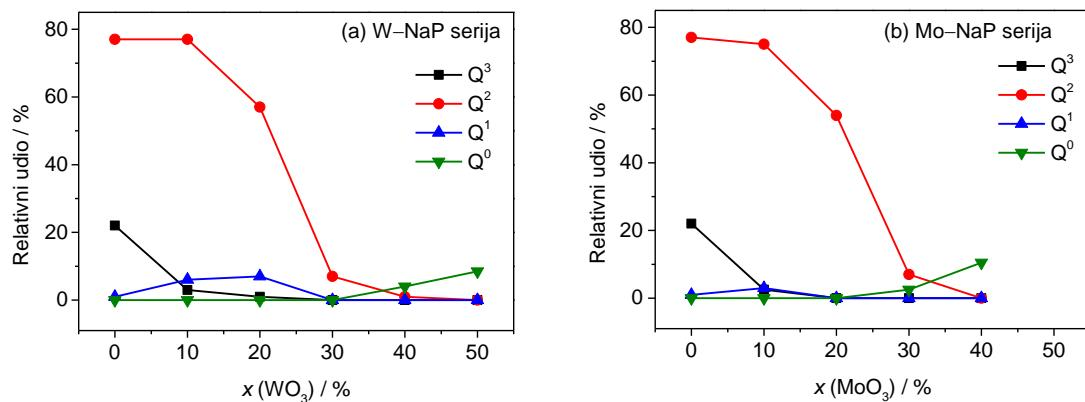
Slika 62. Ovisnost relativnih udjela  $Q^n$  jedinica o sastavu za serije stakala (a)  $xWO_3$ –40Na<sub>2</sub>O–(60– $x$ )P<sub>2</sub>O<sub>5</sub> i (b)  $xMoO_3$ –40Na<sub>2</sub>O–(60– $x$ )P<sub>2</sub>O<sub>5</sub>,  $x = 0$ –50 %.
