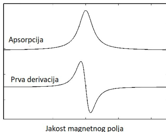
Slika 22. Primjer apsorpcijske linije u EPR spektru i njene prve derivacije.
