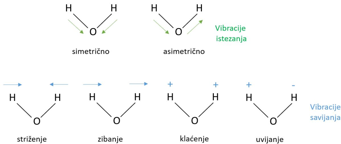
Slika 20. Shematski prikaz vibracija istezanja i savijanja.
