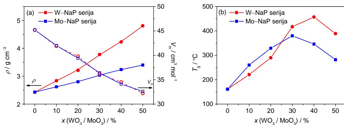
Slika 59. Ovisnost (a) gustoće,  $\rho$ , te molarног volumena,  $V_m$ , i (b) temperature staklišta,  $T_g$ , o množinskom udjelu  $\text{WO}_3$  i  $\text{MoO}_3$  u serijama stakala  $x\text{WO}_3-40\text{Na}_2\text{O}-(60-x)\text{P}_2\text{O}_5$  i  $x\text{MoO}_3-40\text{Na}_2\text{O}-(60-x)\text{P}_2\text{O}_5$ ,  $x = 0-50\%$ .
