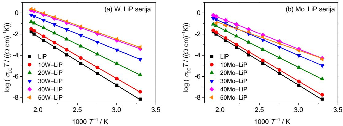
Slika 50. Arrheniusov graf ovisnosti DC provodnosti,  $\sigma_{DC}$ , o recipročnoj temperaturi za stakla iz serija (a)  $x\text{WO}_3\text{--}40\text{Li}_2\text{O}\text{--}(60\text{--}x)\text{P}_2\text{O}_5$  i (b)  $x\text{MoO}_3\text{--}40\text{Li}_2\text{O}\text{--}(60\text{--}x)\text{P}_2\text{O}_5$ ,  $x = 0\text{--}50\%$ .
