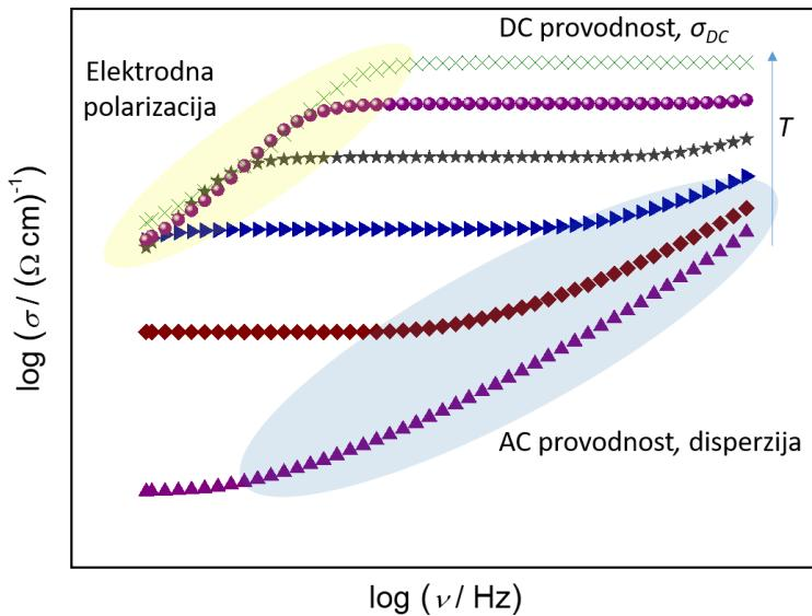
Slika 27. Tipični spektri provodnosti ionski vodljivih stakala u ovisnosti o temperaturi.
