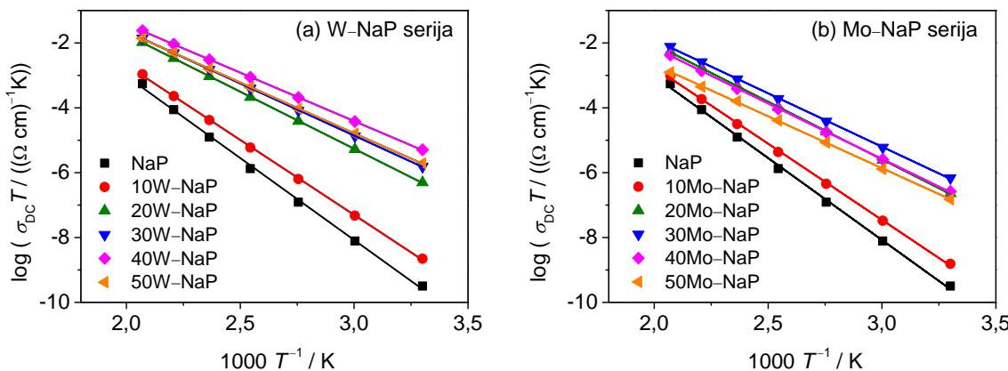
Slika 66. Arrheniusov graf ovisnosti DC provodnosti,  $\sigma_{DC}$ , o recipročnoj temperaturi za stakla iz serija (a)  $x\text{WO}_3\text{--}40\text{Na}_2\text{O}\text{--}(60\text{--}x)\text{P}_2\text{O}_5$  i (b)  $x\text{MoO}_3\text{--}40\text{Na}_2\text{O}\text{--}(60\text{--}x)\text{P}_2\text{O}_5$ ,  $x = 0\text{--}50\%$ .
