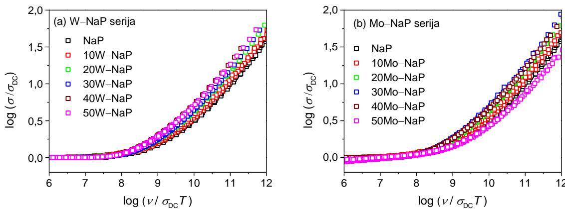
Slika 71. Konstrukcija *super-master* krivulje za stakla iz serija (a)  $x\text{WO}_3\text{--}40\text{Na}_2\text{O}\text{--}(60\text{--}x)\text{P}_2\text{O}_5$  i (b)  $x\text{MoO}_3\text{--}40\text{Na}_2\text{O}\text{--}(60\text{--}x)\text{P}_2\text{O}_5$ ,  $x = 0\text{--}50\%$ , primjenom Summerfieldovog postupka.
