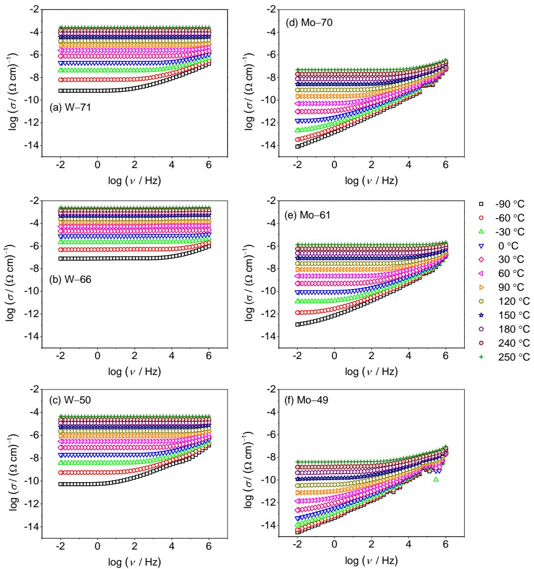
Slika 35. Spektri električne provodnosti pri različitim temperaturama za odabrana stakla iz serija  $x\text{WO}_3-(100-x)\text{P}_2\text{O}_5$  i  $x\text{MoO}_3-(100-x)\text{P}_2\text{O}_5$ ,  $x = 49-81\%$ .
