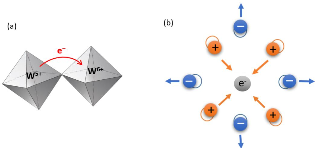
Slika 11. (a) Preskok elektrona s iona prijelaznog metala nižeg na ion višeg oksidacijskog stanja i (b) lokalna distorzija strukture uzrokovana preskokom elektrona – polaron.
