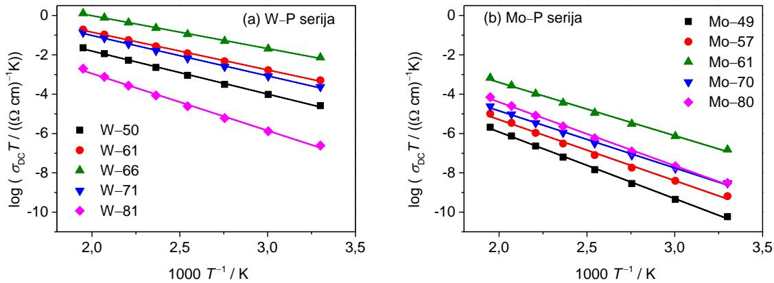
Slika 36. Arrheniusov graf ovisnosti DC provodnosti,  $\sigma_{DC}$ , o recipročnoj temperaturi za stakla iz serija (a)  $x\text{WO}_3-(100-x)\text{P}_2\text{O}_5$  i (b)  $x\text{MoO}_3-(100-x)\text{P}_2\text{O}_5$ ,  $x = 49-81\%$ .
