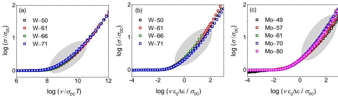
Slika 41. Konstrukcija *super-master* krivulja preklapanjem *master* krivulja dobivenih (a) Summerfieldovim postupkom u  $\text{WO}_3\text{--P}_2\text{O}_5$  staklima, (b) Sidebottomovim postupkom u  $\text{WO}_3\text{--P}_2\text{O}_5$  staklima i (c) Sidebottomovim postupkom u  $\text{MoO}_3\text{--P}_2\text{O}_5$  staklima.
