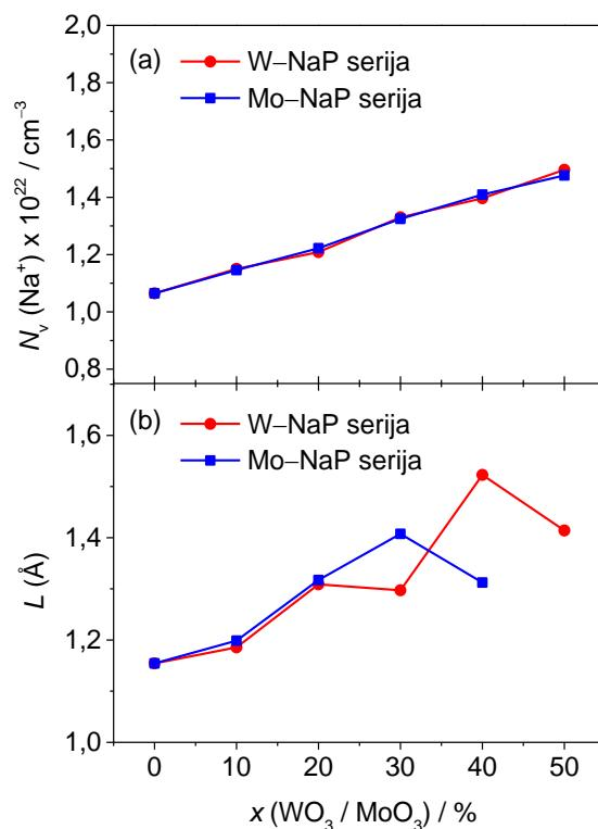
Slika 73. (a) Gustoća broja natrijevih iona,  $N_v (\text{Na}^+) \times 10^{22} / \text{cm}^{-3}$  i (b) Sidebottomova duljina,  $L$ , u ovisnosti o udjelu  $\text{WO}_3$  i  $\text{MoO}_3$  iz serija stakala  $x\text{WO}_3-40\text{Na}_2\text{O}-(60-x)\text{P}_2\text{O}_5$  i  $x\text{MoO}_3-40\text{Na}_2\text{O}-(60-x)\text{P}_2\text{O}_5$ ,  $x = 0-50 \%$ .
