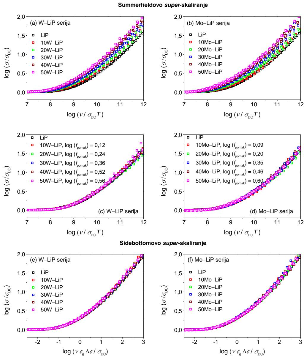
Slika 55. Konstrukcija *super-master* krivulja za stakla iz serija  $x\text{WO}_3\text{--}40\text{Li}_2\text{O}\text{--}(60-x)\text{P}_2\text{O}_5$  i  $x\text{MoO}_3\text{--}40\text{Li}_2\text{O}\text{--}(60-x)\text{P}_2\text{O}_5$ ,  $x = 0\text{--}50\%$ , primjenom (a-d) Summerfieldovog i (e-f) Sidebottomovog postupka. Iznos faktora pomaka,  $\log(f_{\text{pomak}})$ , pojedine krivulje označen je u legendi.
