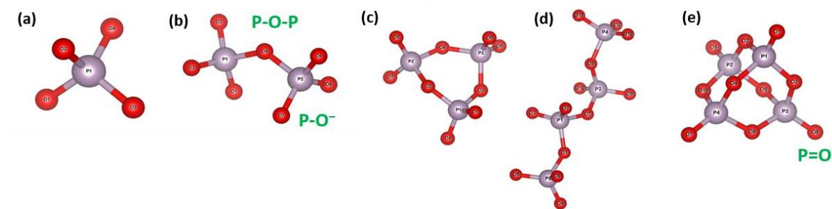
Slika 5. Optimizirane strukture različitih fosfatnih jedinica (a) ortofosfata  $[PO_4]^{3-}$ , (b) pirofosfata  $[P_2O_7]^{4-}$ , (c) cikličke  $[P_3O_9]^{3-}$  molekule, (d) polimernog lanca  $[P_4O_{13}]^{6-}$  te (e) ultrafosfatne  $P_3O_{10}$  molekule.<sup>17</sup>
