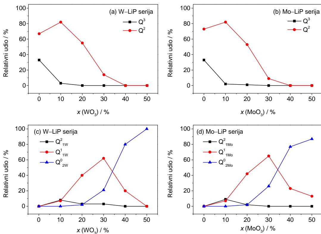
Slika 47. Ovisnost relativnih udjela (a i b)  $Q^n$  jedinica te (c i d) „miješanih“  $Q^n_{m\text{W/Mo}}$  jedinica o sastavu za serije stakala  $x\text{WO}_3\text{--}40\text{Li}_2\text{O}\text{--}(60-x)\text{P}_2\text{O}_5$  i  $x\text{MoO}_3\text{--}40\text{Li}_2\text{O}\text{--}(60-x)\text{P}_2\text{O}_5$ ,  $x = 0\text{--}50 \%$ .
