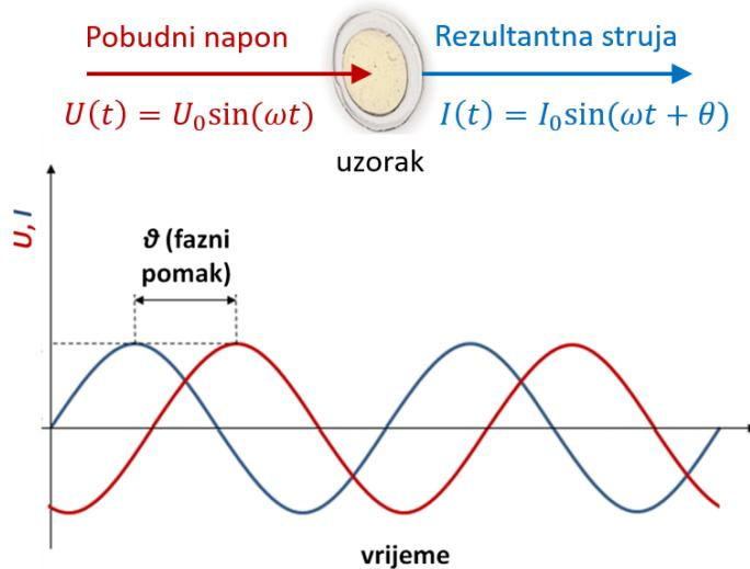
Slika 25. Osnovni princip impedancijske spektroskopije te razlika u fazi primijenjenog napona i rezultantne struje.
