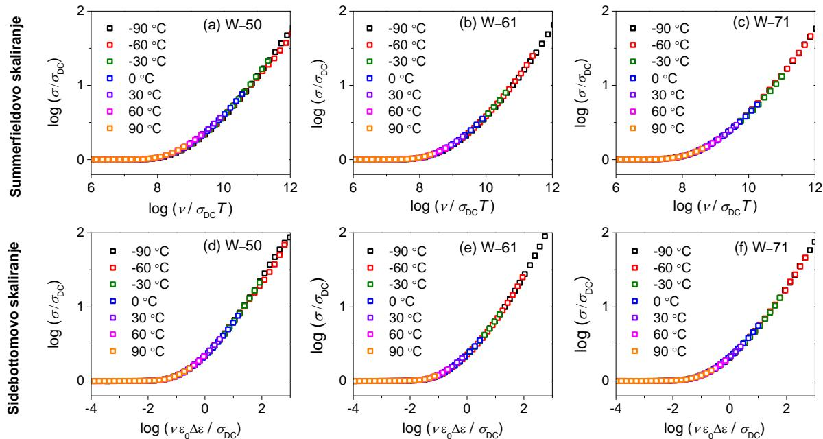
Slika 39. Spektri provodnosti W-50, W-61 i W-71 stakala iz serije  $x\text{WO}_3-(100-x)\text{P}_2\text{O}_5$ ,  $x = 50-81 \%$ , skalirani primjenom (a-c) Summerfieldovog i (d-f) Sidebottomovog postupka.
