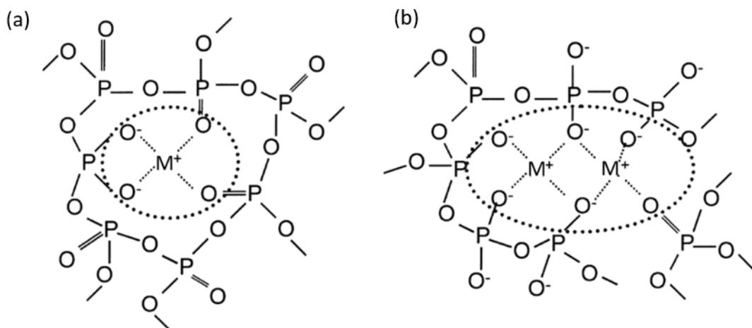
Slika 8. Shematski prikaz koordinacijskog okruženja kationa modifikatora ( $M^+$ ) u fosfatnim staklima u slučaju (a)  $M_{TO} > KB_M$  i (b)  $M_{TO} < KB_M$ .<sup>14</sup>
