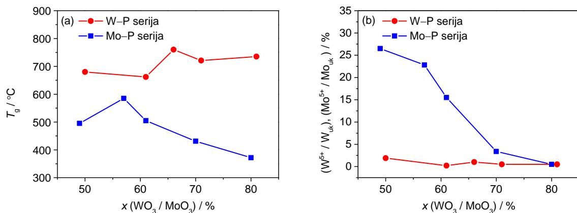
Slika 32. Ovisnost (a) temperature staklišta,  $T_g$ , i (b) omjera  $W^{5+}/W_{uk}$  odnosno  $Mo^{5+}/Mo_{uk}$  o množinskom udjelu  $WO_3$  i  $MoO_3$  u serijama stakala  $xWO_3-(100-x)P_2O_5$  i  $xMoO_3(100-x)P_2O_5$ ,  $x = 49-81$  %.
