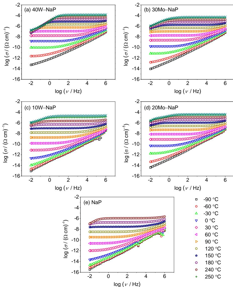
Slika 65. Spektri električne provodnosti pri različitim temperaturama za odabrana stakla iz serija  $x\text{WO}_3\text{--}40\text{Na}_2\text{O}\text{--}(60\text{--}x)\text{P}_2\text{O}_5$  i  $x\text{MoO}_3\text{--}40\text{Na}_2\text{O}\text{--}(60\text{--}x)\text{P}_2\text{O}_5$ ,  $x = 0\text{--}50\text{ }\%$ .
