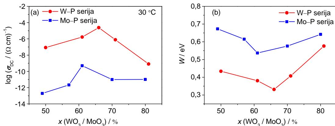
Slika 37. Ovisnost (a) DC provodnosti na  $30^\circ\text{C}$  i (b) energije aktivacije za DC provodnost o množinskom udjelu  $\text{WO}_3$  i  $\text{MoO}_3$  u serijama stakala  $x\text{WO}_3-(100-x)\text{P}_2\text{O}_5$  i  $x\text{MoO}_3-(100-x)\text{P}_2\text{O}_5$ ,  $x = 49-81\%$ .
