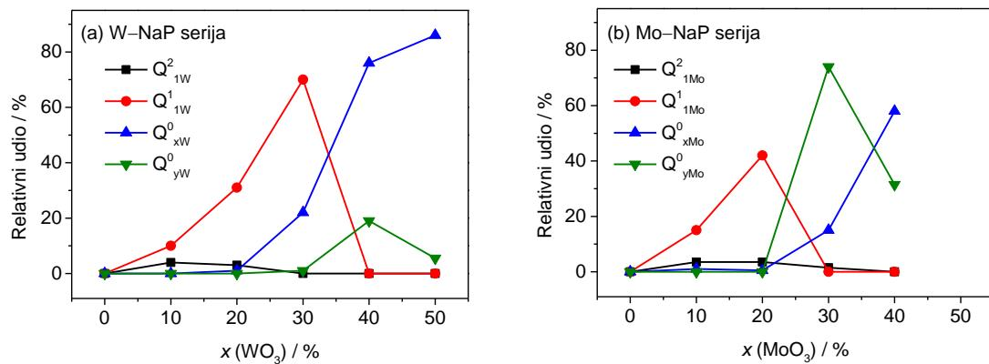
Slika 63. Ovisnost relativnih udjela  $Q^n_{mW/Mo}$  jedinica o sastavu za serije stakala (a)  $xWO_3$ –40Na<sub>2</sub>O–(60– $x$ )P<sub>2</sub>O<sub>5</sub> i (b)  $xMoO_3$ –40Na<sub>2</sub>O–(60– $x$ )P<sub>2</sub>O<sub>5</sub>,  $x = 0$ –50 %.
