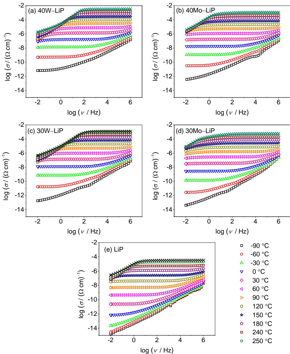
Slika 49. Spektri električne provodnosti pri različitim temperaturama za odabrana stakla iz serija  $x\text{WO}_3\text{--}40\text{Li}_2\text{O}\text{--}(60-x)\text{P}_2\text{O}_5$  i  $x\text{MoO}_3\text{--}40\text{Li}_2\text{O}\text{--}(60-x)\text{P}_2\text{O}_5$ ,  $x = 0\text{--}50\%$ .
