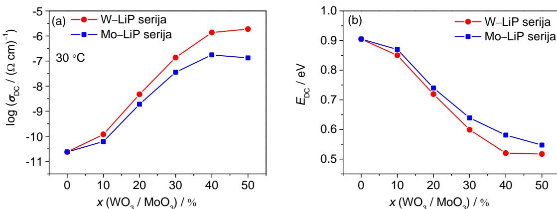
Slika 51. Ovisnost (a) DC provodnosti na  $30^\circ\text{C}$  i (b) energije aktivacije za DC provodnost o množinskom udjelu  $\text{WO}_3$  i  $\text{MoO}_3$  u serijama stakala  $x\text{WO}_3\text{--}40\text{Li}_2\text{O}\text{--}(60-x)\text{P}_2\text{O}_5$  i  $x\text{MoO}_3\text{--}40\text{Li}_2\text{O}\text{--}(60-x)\text{P}_2\text{O}_5$ ,  $x = 0\text{--}50\%$ .
