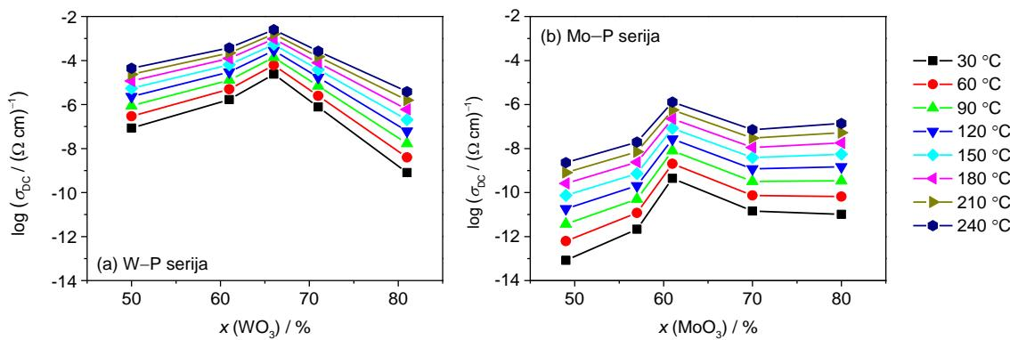
Slika D3. Ovisnost DC provodnosti na različitim temperaturama o udjelu  $\text{WO}_3$  odnosno  $\text{MoO}_3$  za stakla iz serija (a)  $x\text{WO}_3-(100-x)\text{P}_2\text{O}_5$  i (b)  $x\text{MoO}_3-(100-x)\text{P}_2\text{O}_5$ ,  $x=49-81\%$ .
