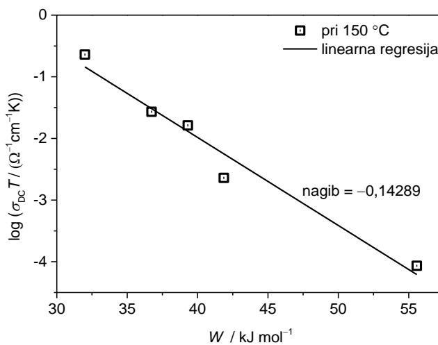
Slika D2. Linearna regresija ovisnosti energije aktivacije  $W$  o  $\log(\sigma_{DC} T)$  za seriju stakala  $x\text{WO}_3-(100-x)\text{P}_2\text{O}_5$ ,  $x = 50\text{--}81\%$ .
