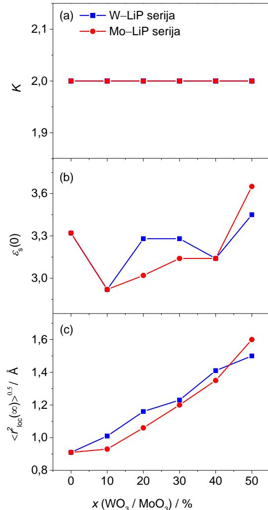
Slika 58. Trendovi ovisnosti (a) parametra  $K$ , (b) plateau-a skalirane permitivnosti,  $\varepsilon_s(0)$ , i (c) prostornog dosega lokaliziranih skokova iona natrija,  $\langle r_{loc}^2(\infty) \rangle^{0.5}$ , o udjelu  $\text{WO}_3$  i  $\text{MoO}_3$  u serijama stakala  $x\text{WO}_3\text{--}40\text{Li}_2\text{O}\text{--}(60\text{--}x)\text{P}_2\text{O}_5$  i  $x\text{MoO}_3\text{--}40\text{Li}_2\text{O}\text{--}(60\text{--}x)\text{P}_2\text{O}_5$ ,  $x = 0\text{--}50\text{ }%$ .
