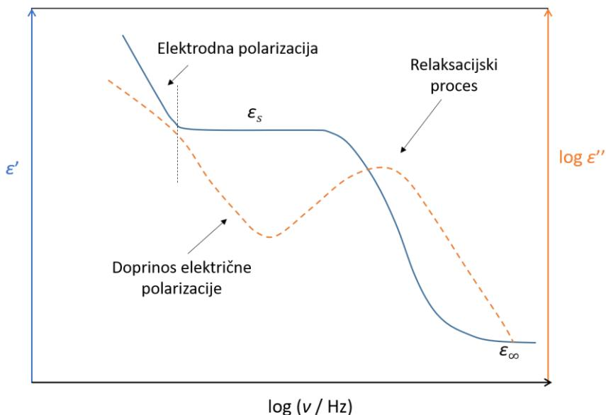
Slika 28. Ovisnost realnog i imaginarnog dijela permitivnosti o frekvenciji.
