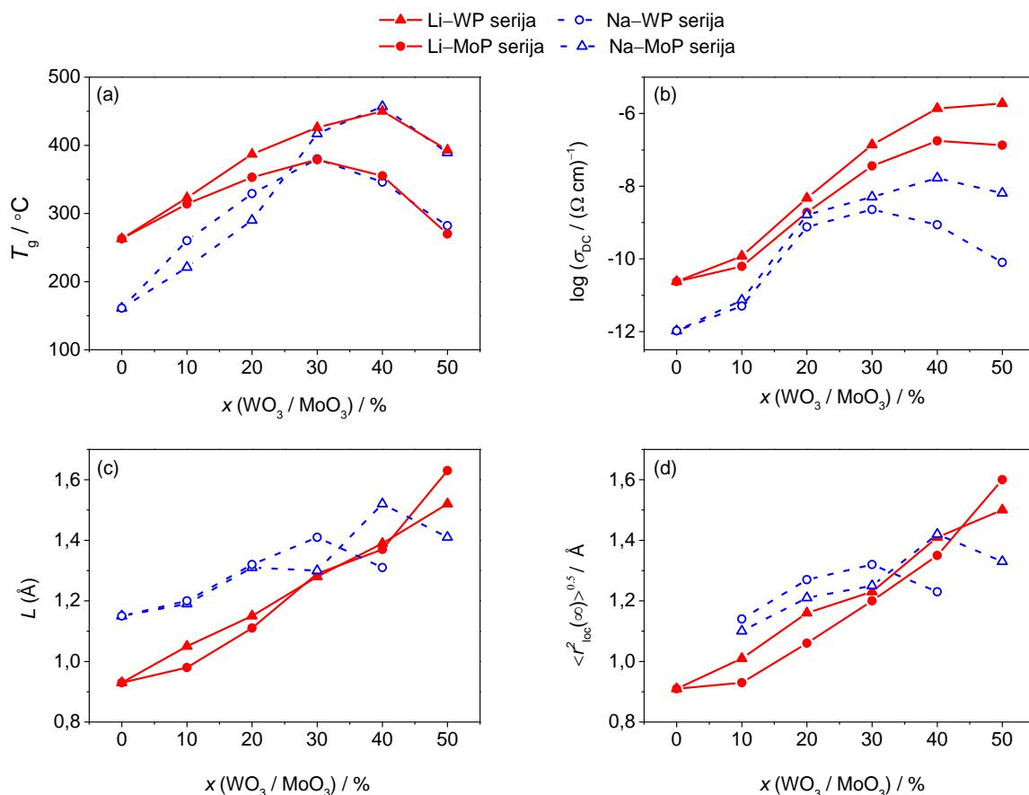
Slika 76. Usporedbe trendova ovisnosti (a) temperature staklišta,  $T_g$ , (b) DC provodnosti na 30 °C,  $\sigma_{DC}$ , (c) Sidebottomove duljine,  $L$ , i (d) dosega lokaliziranog preskoka iona,  $\langle r_{loc}^2(\infty) \rangle$ , o udjelu  $\text{WO}_3$  i  $\text{MoO}_3$  za litijeve i natrijeve serije stakala.
