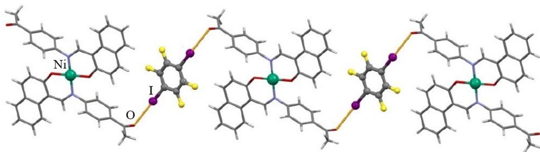
**Slika 10.** Jednodimenzionalni motiv lanca u kokristalu koordinacijskog spoja nikla(II) i donora halogenske veze **14tfib** nastao povezivanjem molekula halogenskom vezom I···O (ZEQLEP)<sup>61</sup>
