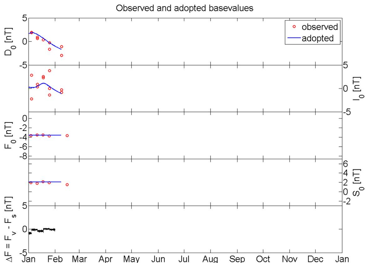
Slika 2.2 – Opažene (*engl.* observed) i prilagođene (*engl.* adopted) kalibracijske vrijednosti za DIDD variometer. Na slici su također prikazani rezultati motrenja s početka veljače koji su korišteni za u izračunu kalibracijskih krivulja za siječanj.
