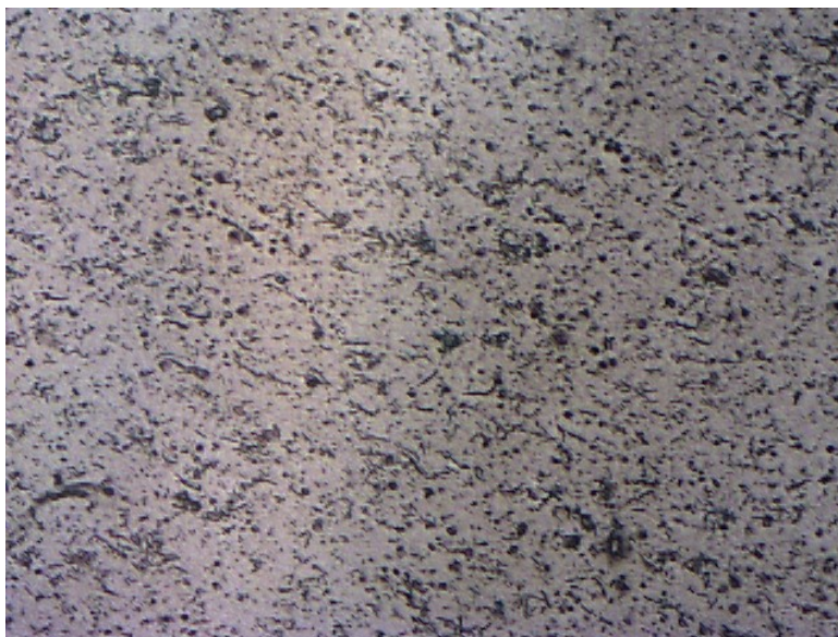
Slika 30. Površina (110) plohe monokristala fluorita nakon otapanja na području 500 \mu\text{m} \times 400 \mu\text{m} dobivena optičkim mikroskopom.
