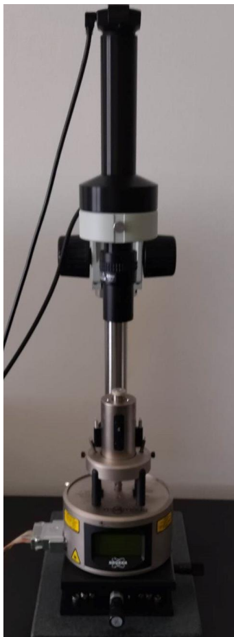
Slika 37. Mikroskop atomskih sila (Multimode 8, Bruker)
