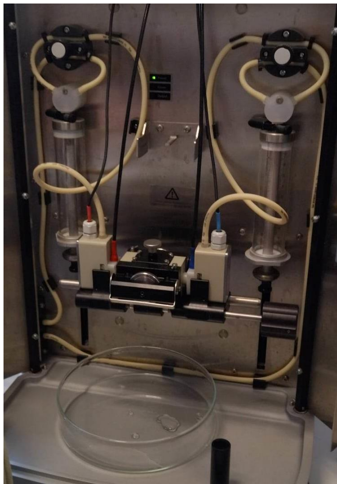
Slika 39. Uređaj za mjerenje potencijala strujanja - SurPASS Electrokinetic Analyzer, (Anton Paar GMBH, Austrija)
