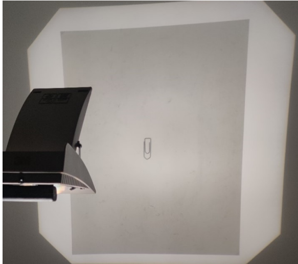
Slika 6.25: Svjetlost grafoskopa kroz polarizator položen vertikalno
