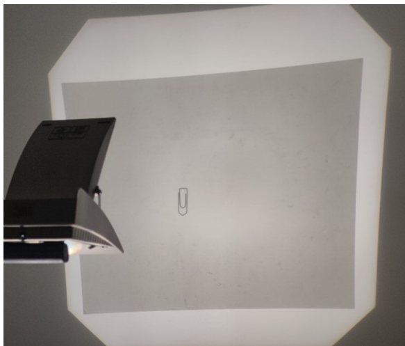
Slika 6.26: Svjetlost grafoskopa kroz polarizator položen horizontalno
