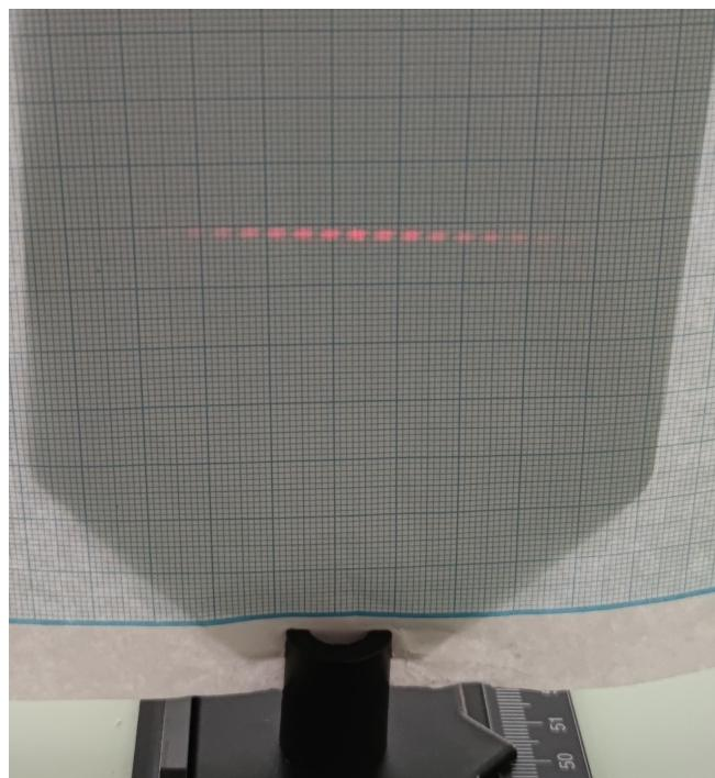
Slika 6.8: Interferencijska slika,  $d = 80 \mu m$ ,  $a = 50 cm$
