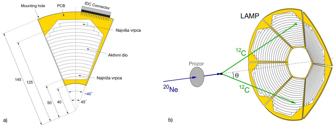
Slika 3.15: Shema detektora za novi postav.
