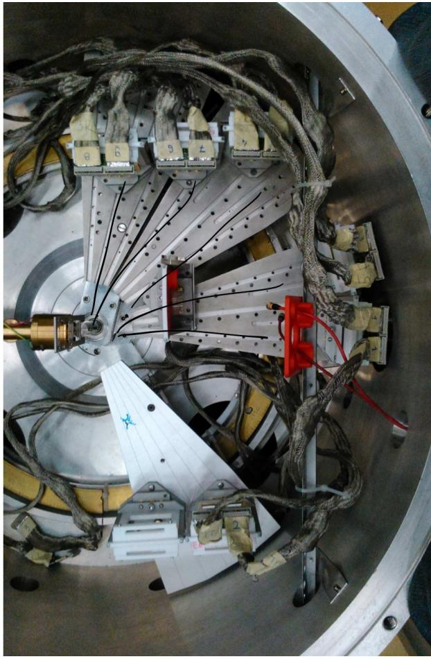
Slika 2.6: Fotografija komore za mjerjenje sa postavljenim detektorima na nosačima. Ima ukupno samostojećih 6 DSSD detektora i jedan teleskop sastavljen od jednog DSSD i jednog SSSD detektora.
