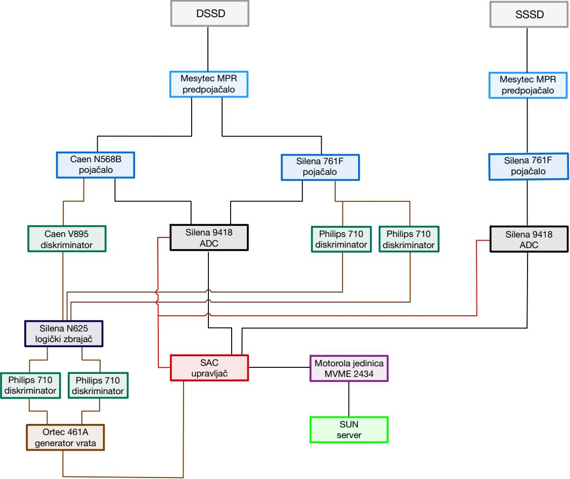
Slika 2.7: Shema elektronike korištene za mjerjenje.
