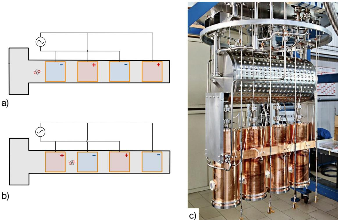
Slika 2.5: Princip rada linearog ubrzivača:
