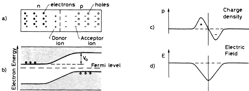
Slika 1.4: *pn*-spoј на slici a), energijske vrpce kroz *pn*-spoј на slici b), gustoća naboja u *pn*-spoju na slici c) i intenzitet generiranog električnog polja na slici d) [18].
