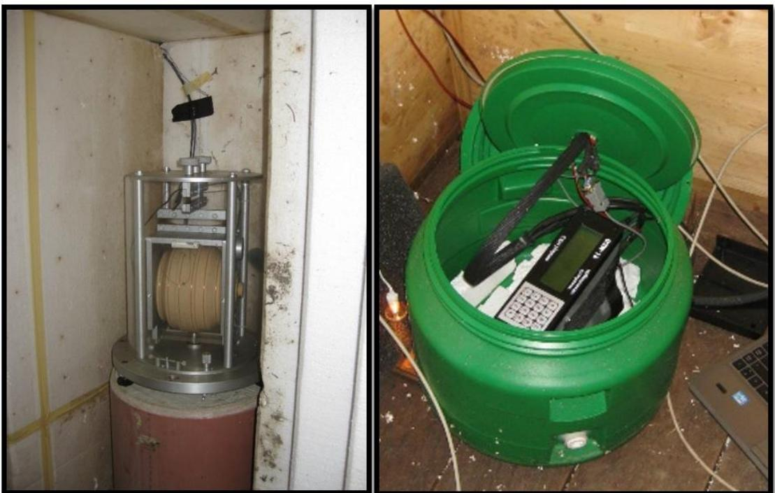
Slika 1.4 – Lijevo: Ovješeni (*engl. suspended*) DIDD senzor koji mjeri na V-pilaru u variometarskoj kući. Oko senzora je postavljena izolacijska kutija kako bi se osigurala bolja temperaturna stabilnost. Desno: Električna jedinica DIDD magnetometra (GSM-19FD).
