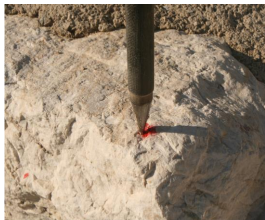
Slike 15 i 16. Označavanje markera i mjerenje prostornih koordinata GPS prijamnikom (Fotografirala: K. Pikelj, 2015.).
