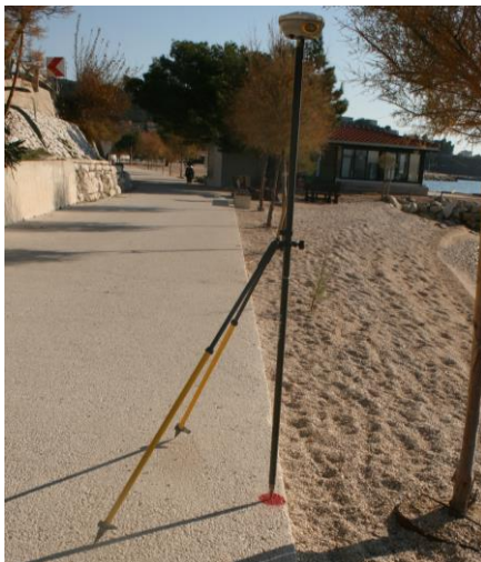
Slike 15 i 16. Označavanje markera i mjerenje prostornih koordinata GPS prijamnikom (Fotografirala: K. Pikelj, 2015.).
