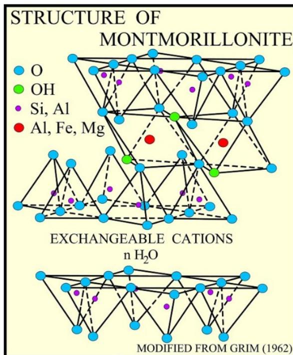
Slika 2: Struktura montmorillonita [2]
