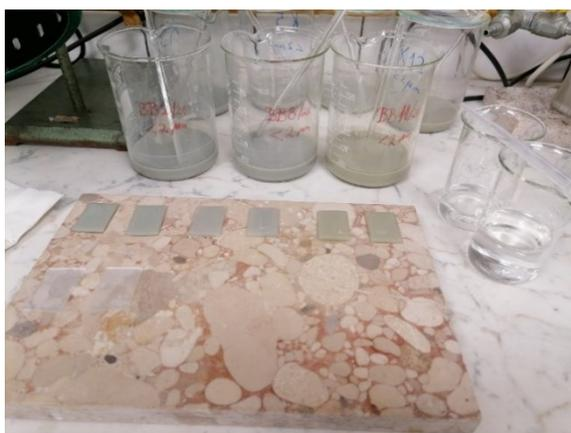
Slika 15: Priprema orijentiranih preparata za određivanje minerala gline u uzorcima.
