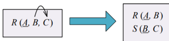
Slika 2.6: Shematski prikaz prevođenja u 3NF [6]
