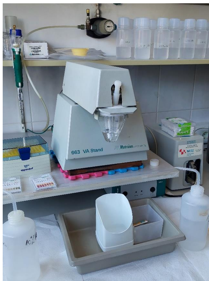
Slika 3.12. Multimodni potenciostat ECO Chemie \mu AUTOLAB spojen s tro-elektrodnim sustavom Metrohm 663 VA STAND.
