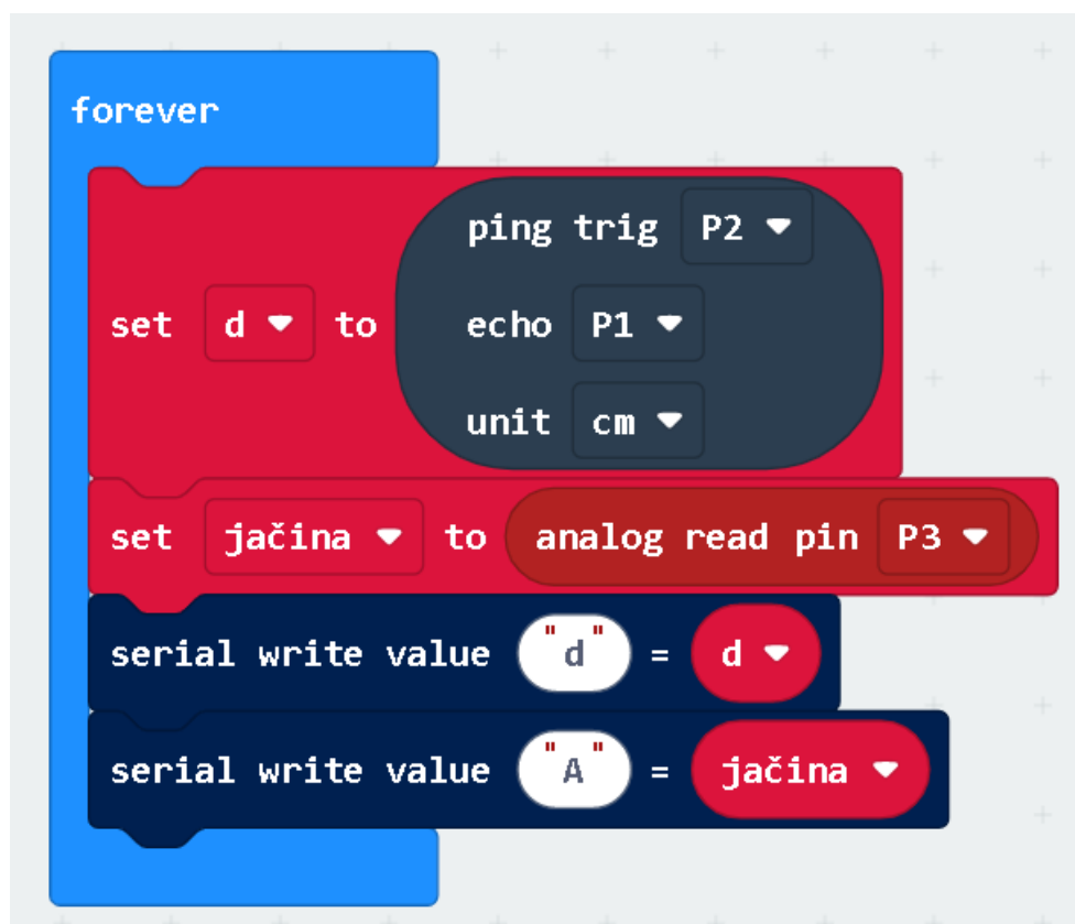
Slika 4.9: Programski kôd za mjerenje interferencije zvuka i udaljenosti od drugog zvučnika
