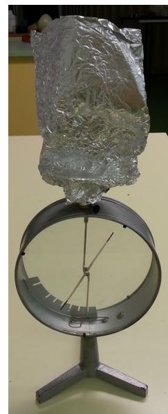
Slika 5.2: Elektroskop s aluminijskom folijom
