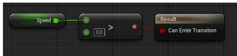
Slika 4.7: Prijelaz iz stanja Idle u stanje Run
