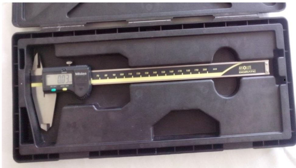
Slika 8. Digitalno pomično mjerilo (raspona 0 do 15 cm, preciznosti 0,01 mm) (foto: B. Šimunić).
