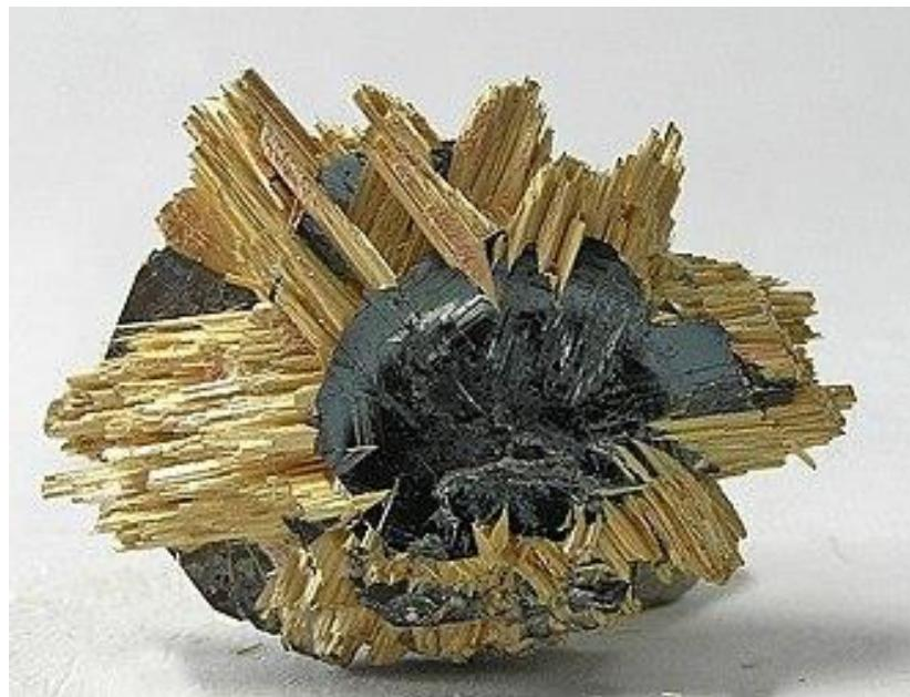
Slika 6. Primjer epitaksije, rast rutila (TiO<sub>2</sub>) na hematitu (Fe<sub>3</sub>O<sub>4</sub>), slika je preuzeta i prilagođena prema izvoru<sup>14</sup>
