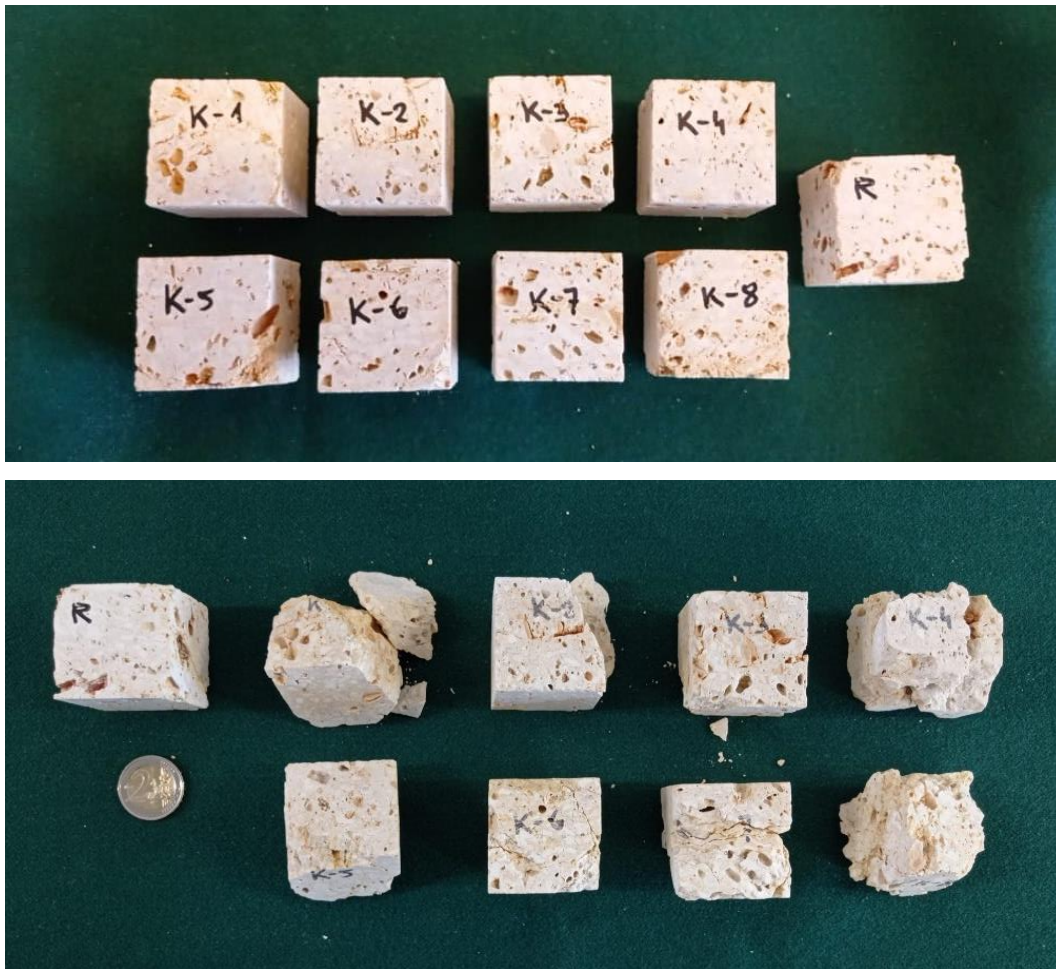
Slika 5. Uzorci litotamnijskog vapnenca prije (slika gore) i nakon 15 ciklusa ispitivanja otpornosti na kristalizaciju soli (slika dolje)
