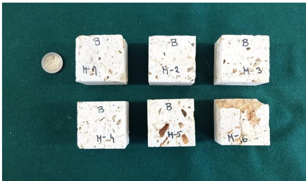
Slika 8. Uzorci litotamnijskog vapnenca nakon 25 ciklusa ispitivanja otpornosti na djelovanje mraza
