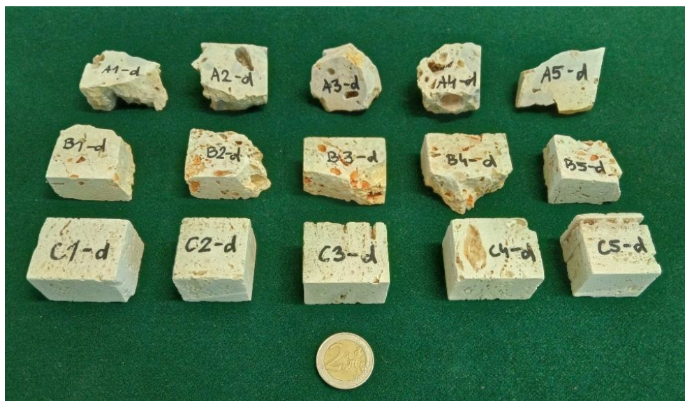
Slika 13. Uzorci litavca (prvi red, oznaka A), litotamnijskog vapnenca (drugi red, oznaka B) i travertina (treći red, oznaka C) nakon 5 ciklusa ispitivanja Slake durability test -om u destiliranoj vodi (d).
