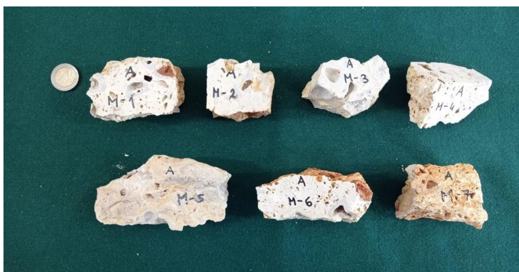
Slika 7. Uzorci litavca nakon 25 ciklusa ispitivanja otpornosti na djelovanje mraza
