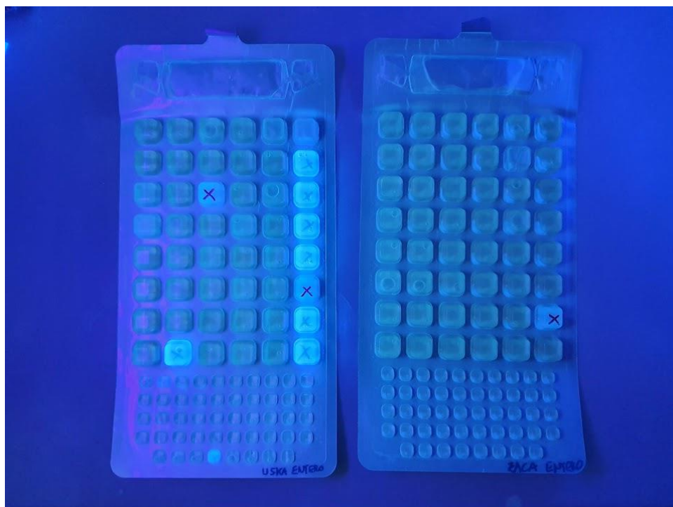
Slika 4.7-4: Promatranje fluorescencije (bazenčići koji fluoresciraju potvrđeno su pozitivni na enterokoke) na Quantitray2000® pladnjevima prilikom Enterolert-E® testiranja (Fotografirao: Ivan Lakuš)
