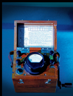
Ispitivač izolacije s induktorom, 1927.
