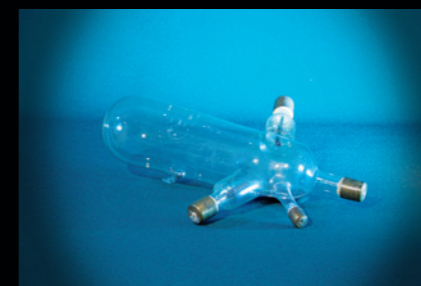
Gaedeov molvakuummetar, zaštitni ventil, 1938.
