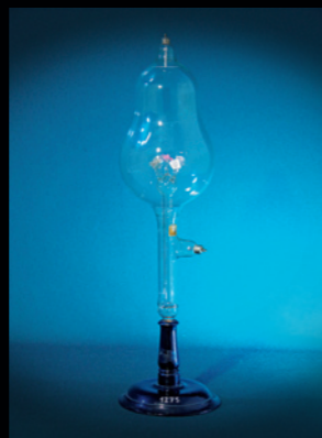
Ekstravelika Crookesova cijev sa 5 ruda na stalku 30. 5. 1918.
