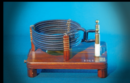
Teslin transformator s uzvojnicom za ugađanje, 1940.
