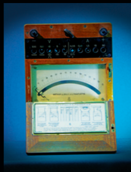
Univerzalni instrument s pokretnim okvirom 30. 3. 1927.
