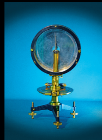
Inklinatorij po Meyersteinu sa 2 igle, magnetom i koritom 8. 6. 1904.
