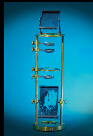
Polarizaciona sprava za paralelno svijetlo 29. 3. 1876.
