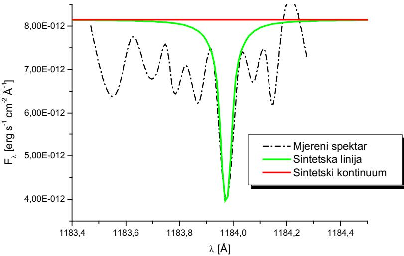
Slika 63. Mjereni spektar u rasponu oko linije Zr IV  $\lambda 1184$  u usporedbi sa sintetskom linijom i sintetskim kontinuumom dobivenim programom SYNTLINE. Korišten je model atmosfere dobiven ekstrapolacijom Koesterovih modela bijelih patuljaka uz parametre  $\log g = 5$  i  $T_{\text{eff}} = 30\,000$  K.
