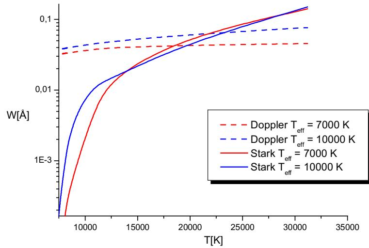
Sl. 37. Usporedba Starkovih i Dopplerovih širina za Lu III liniju  $\lambda 8010.9$  u ovisnosti o temperaturi atmosferskog sloja vruće zvijezde za dva različita modela atmosfere  $\log g = 4.5$ ,  $T_{eff} = 7000$  K i  $T_{eff} = 10\,000$  K (Kurucz, 1979)
