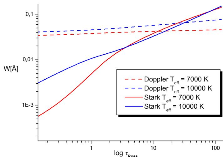
Sl. 36. Usporedba Starkovih i Dopplerovih širina za Lu III liniju  $\lambda 8010.9$  u ovisnosti o optičkoj dubini atmosfere vruće zvijezde za dva različita modela atmosfere  $\log g = 4.5$ ,  $T_{eff} = 7000$  K i  $T_{eff} = 10\,000$  K (Kurucz, 1979)
