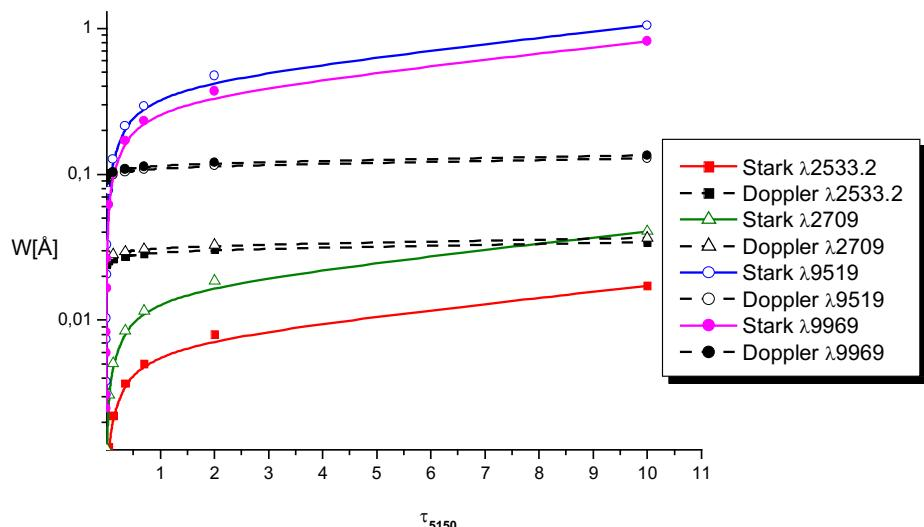
Sl. 44. Starkovo i Dopplerovo širenje spektralnih linija  $\lambda 2533.2$ ,  $\lambda 2709$ ,  $\lambda 9519$  i  $\lambda 9969$  kao funkcije optičke dubine atmosfere DA bijelog patuljka (Majlinger i dr., 2021). Korišteni su parametri modela  $T_{eff} = 15\,000$  K and  $\log g = 8$  (Wickramasinghe, 1972).
