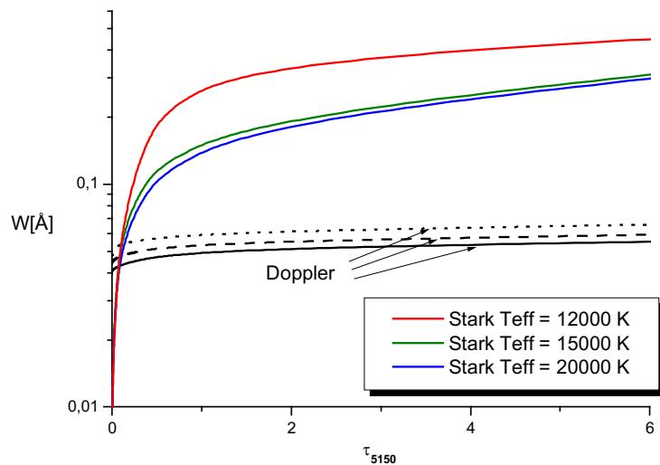
Sl. 32. Usporedba Starkovih i Dopplerovih širina za Lu III liniju  $\lambda 8010.9$  u ovisnosti o optičkoj dubini atmosfere DA bijelog patuljka za tri različita modela atmosfere:  $\log g = 8$ ,  $T_{eff} = 12000$  K,  $T_{eff} = 15\ 000$  K i  $T_{eff} = 20000$  K (Wickramasinghe, 1972)
