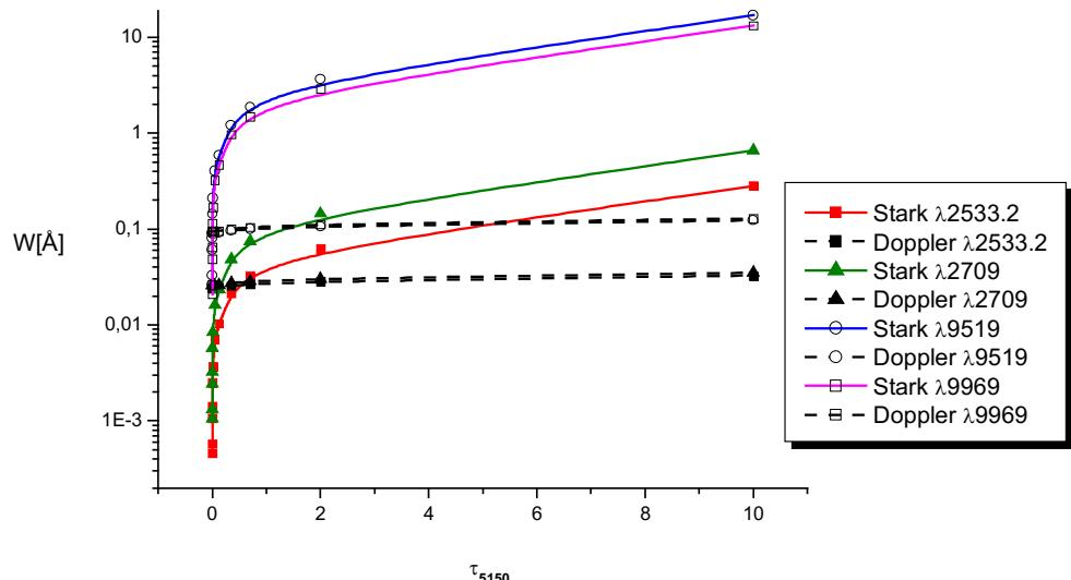
Sl. 46. Starkovo i Dopplerovo širenje spektralnih linija  $\lambda 2533.2$ ,  $\lambda 2709$ ,  $\lambda 9519$  i  $\lambda 9969$  kao funkcije optičke dubine atmosfere DB bijelog patuljka (Majlinger i dr., 2021). Korišteni su parametri modela  $T_{eff} = 15\,000$  K and  $\log g = 8$  (Wickramasinghe, 1972)
