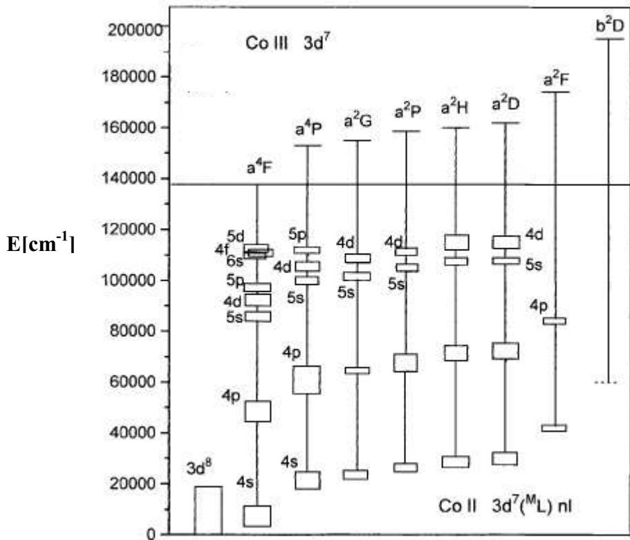
Slika 40. Struktura “normalnog” sustava konfiguracije  $3d^7(^M\text{L})\text{nl}$  relativno na strukturu termova roditeljske konfiguracije  $3d^7$  u Co III (Pickering i dr., 1998)
