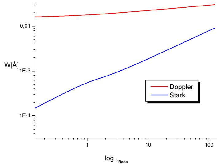
Sl. 6 Usporedba Starkovih i Dopplerovih širina za Zr IV liniju  $\lambda 2287.38$  u ovisnosti o logaritmu Rosselandove optičke dubine atmosfere A-tipa zvijezde prema modelu atmosfere  $\log g = 4.5$  i  $T_{eff} = 10\,000$  K (Kurucz, 1979)
