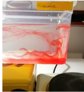
Slika 4.25 Voda se u donjem desnom dijelu posude zagrijava od prijenosnog štednjaka što vidimo po uzdizanju crvene boje koju smo kapnuli
