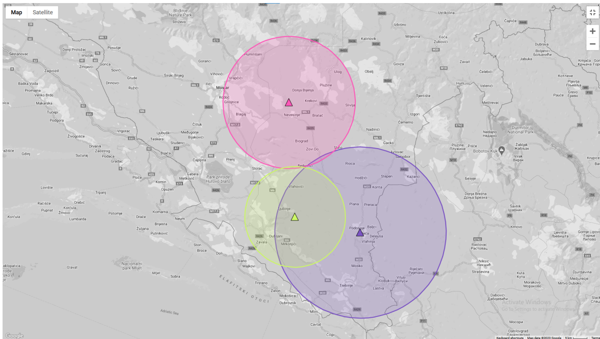
Slika 2.4. Primjer triangulacije izrađen u aplikaciji Earthquake Triangulation (URL7).
