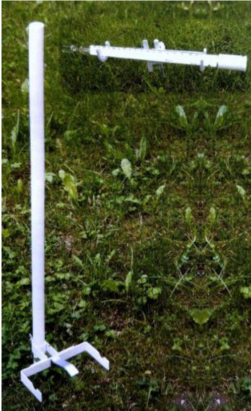
Slika 9. Stalak minimalnog termometra pri zemlji 22
