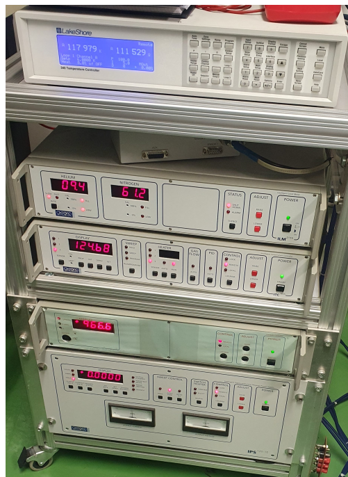
(b) Uređaj za kontrolu temperature uzorka, indikator količine kriogenih tekućina u kriostatu, uređaj za kontrolu VTI-a, pomoćni uređaj za kontrolu VTI-a te napajanje supravodljivog magneta.
