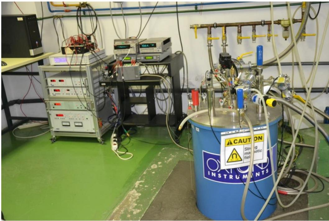
Slika 3.7: 18 T supravodljivi magnet s varijabilnim temperaturnim umetkom.
