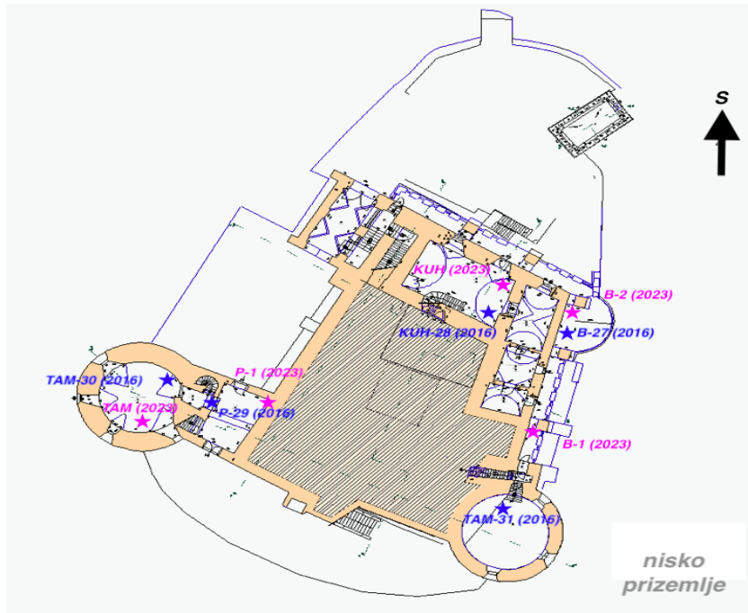
Slika 5.11: Prikaz lokacija mjerenja ambijentalnih vibracija u niskom prizemlju dvorca Trakošćan 2016. i 2023. godine. Ružičastim zvijezdama označene su lokacije mjerenja 2023. godine i plavim zvijezdama mjerenja 2016. godine. (izvor: ustupljeno od strane uprave dvorca Trakošćan)
