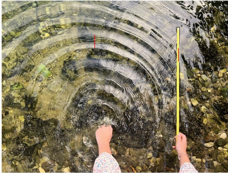
Slika 8. Mjerenje valne duljine kružnog vala na vodi
