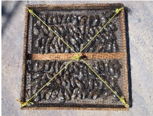
Slika 8 Kavez s dagnjama korišten u transplant eksperimentu
