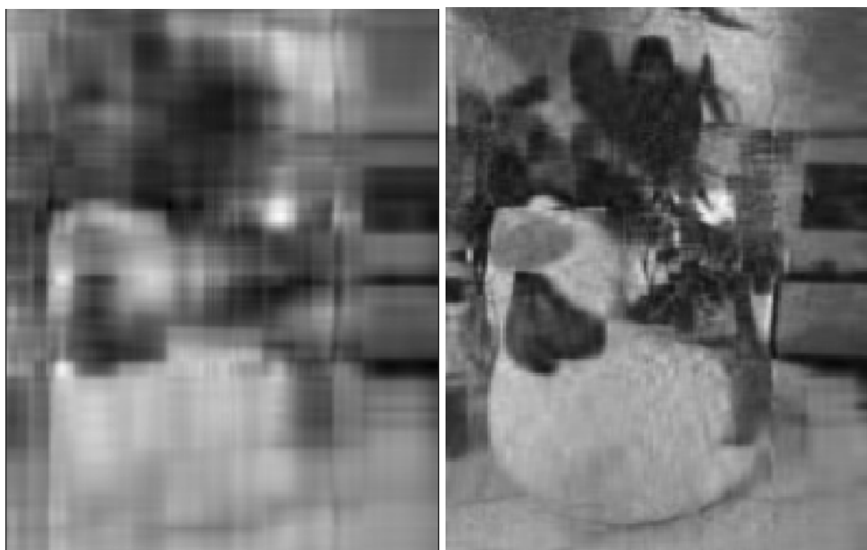
(a) veličina: 1917 \cdot 5 + 5 + 5 \cdot 1515 = 17165 px, (b) veličina: 1917 \cdot 20 + 20 + 20 \cdot 1515 = 68660 , omjer kompresije: 2904255/17165 = 169.20 omjer kompresije: 2904255/68660 = 42.30
