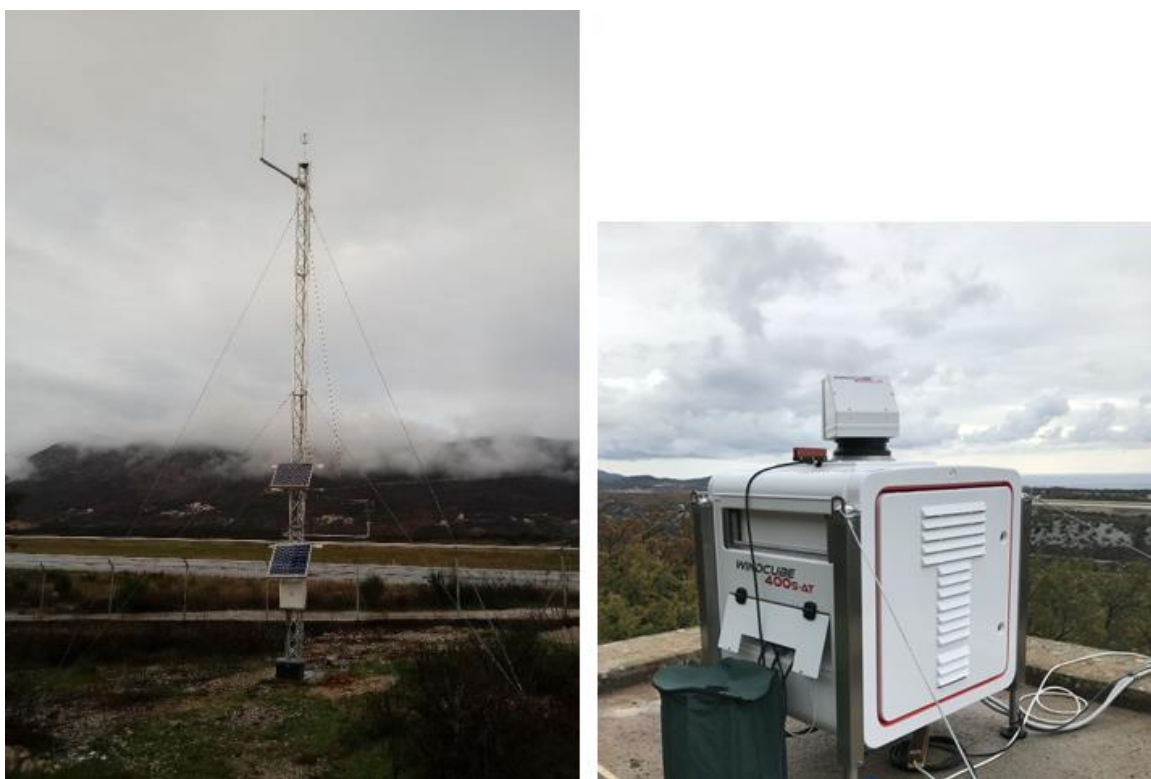
Slika 2.1. Meteorološki stup (lijevo) i LIDAR (desno) koji su bili postavljeni u blizini zračne luke Dubrovnik u razdoblju od 8.12.2017. do 31.3.2018. (izvor: Večenaj i sur. 2020)
