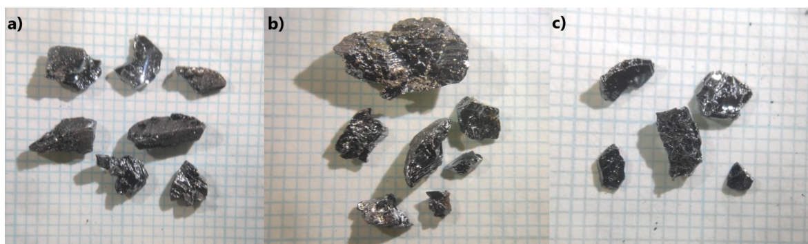
Slika 5.4: a) U drugoj sintezi \text{EuCd}_2\text{As}_2 ponovno su dobiveni kvalitetni kristalići zadovoljavajuće veličine. b) Kristali dobiveni recikliranjem \text{EuCd}_2\text{As}_2 iz prve dvije sinteze. c) \text{EuCd}_2\text{As}_2 dobiven od europija koji je bio skladišten u mineralnom ulju.
